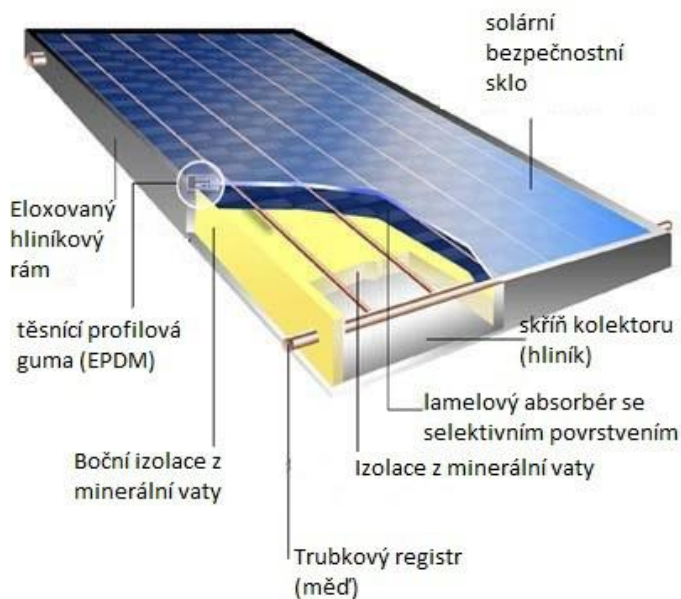
Obrázek 8: Části solárního kolektoru
