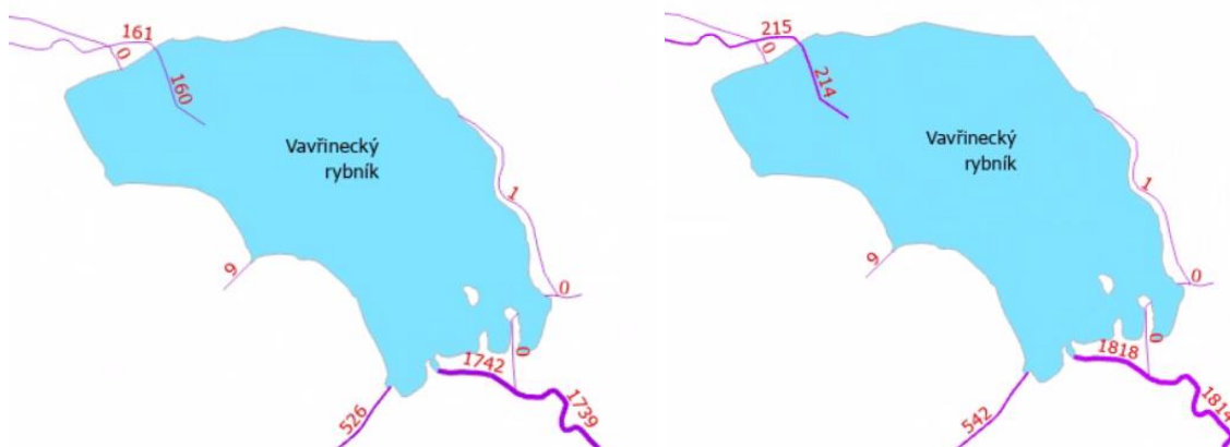
Obrázek 23 - Vavřínecký rybník-srovnání množství sedimentu (vlevo průtok 1, vpravo průtok 2)
