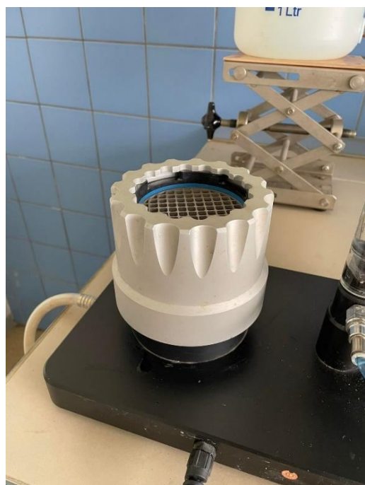
Obrázek 26: Testovaný vzorek upevněný hliníkovým víkem
