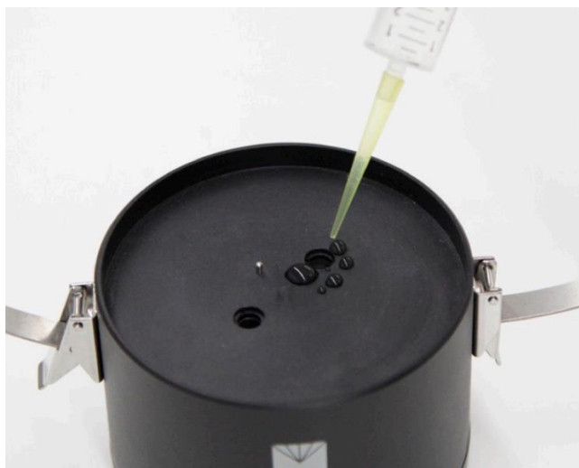
Obrázek 19: Nasycení čidel pod tenzometry demineralizovanou vodou (převzato z METER Group AG, 2017)
