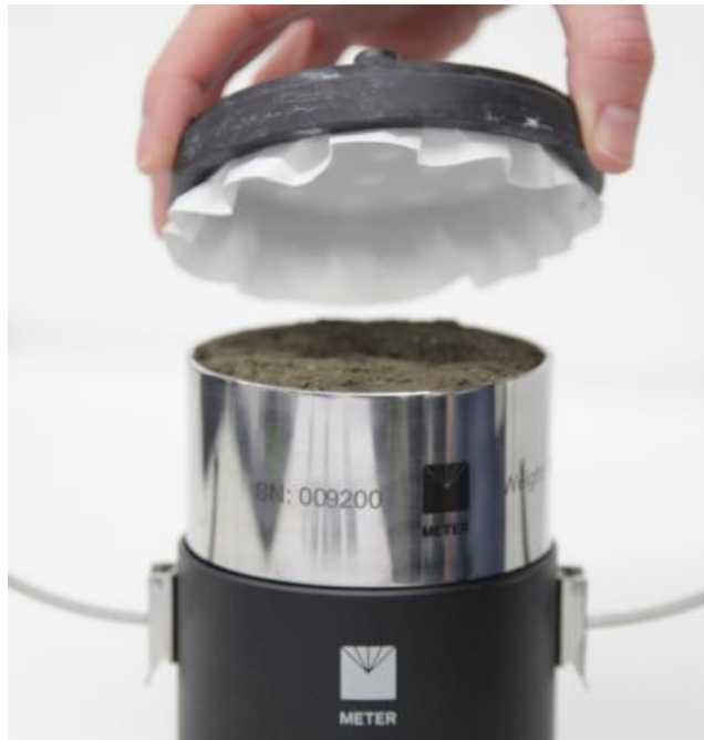
Obrázek 31: vložení testovacího vzorku na měřicí podstavec HYPROP (převzato z METER Group AG, 2017)
