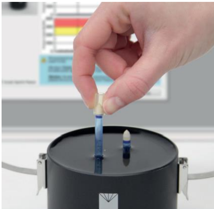
Obrázek 30: Vložení tenzometrů do HYPROP podstavce (převzato z METER Group AG, 2017)
