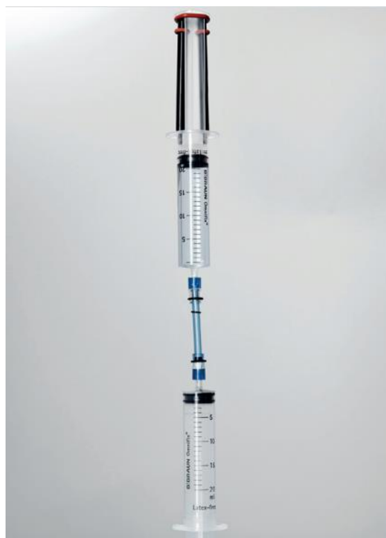
Obrázek 18: Nasycení tenzometrů demineralizovanou vodou (převzato z METER Group AG, 2017)
