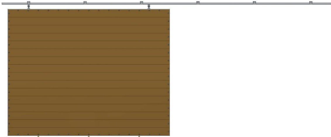
Obr. 26.: Kolejnice s úchyty a vraty v krajní poloze
