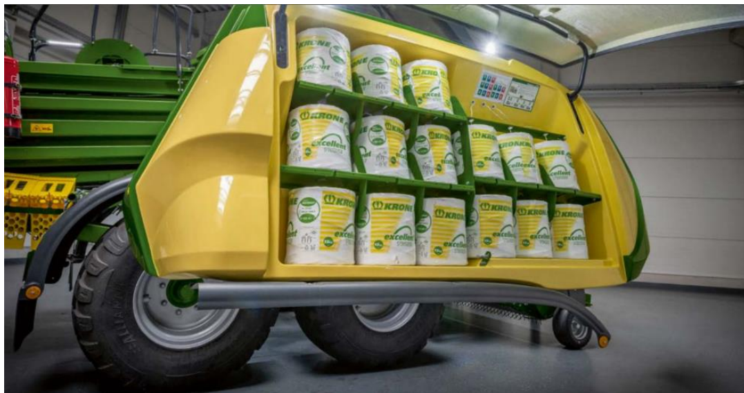
Obrázek 30: Uložení rolí provázku v lisu Krone BiG Pack [27]
