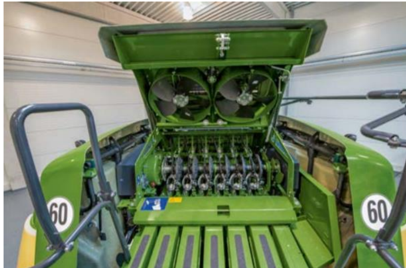
Obrázek 27: Schéma ventilace uvnitř lisu John Deere L1500 [31]
