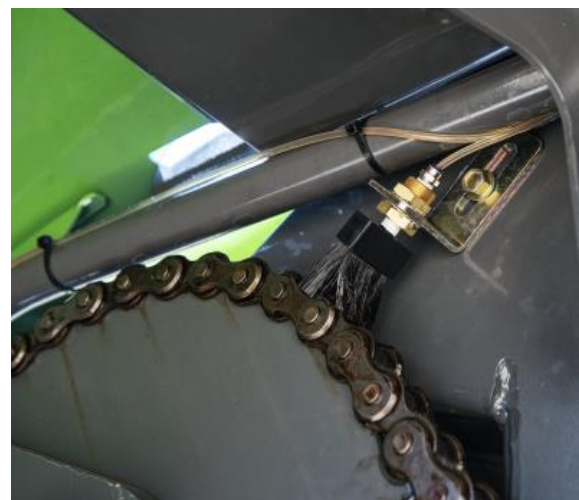
Obrázek 26: Mazání řetězu kartáčkem [28]
