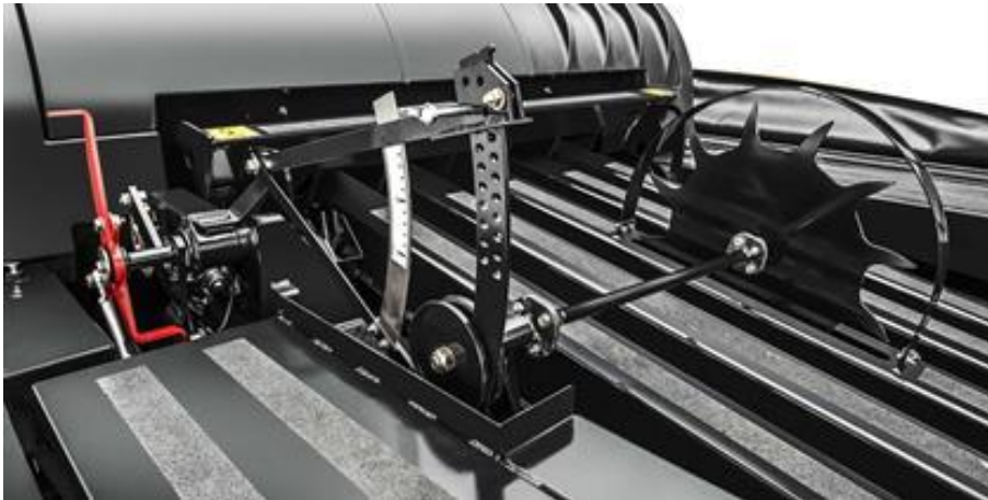
Obrázek 16: Ostruhové kolo pro snímání délky balíku [26]
