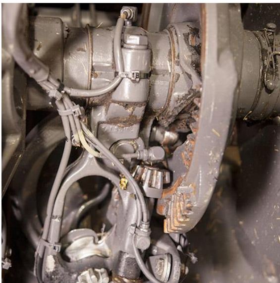
Obrázek 25: Detail vazače s hadičkami mazání [32]
