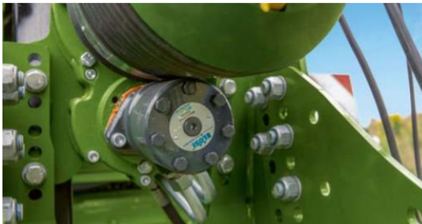
Obrázek 20: Hydraulická podpora rozběhu lisu Krone BigPack [27]
