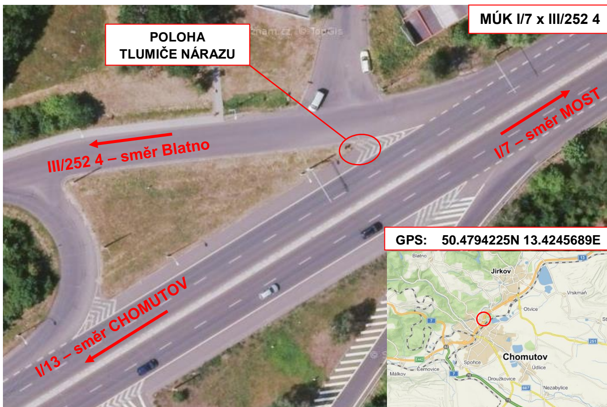
Obrázek 46 – Poloha tlumiče nárazu v hrotu přídatného jízdního pruhu MÚK silnic I/13 x III/252 4. [1]
