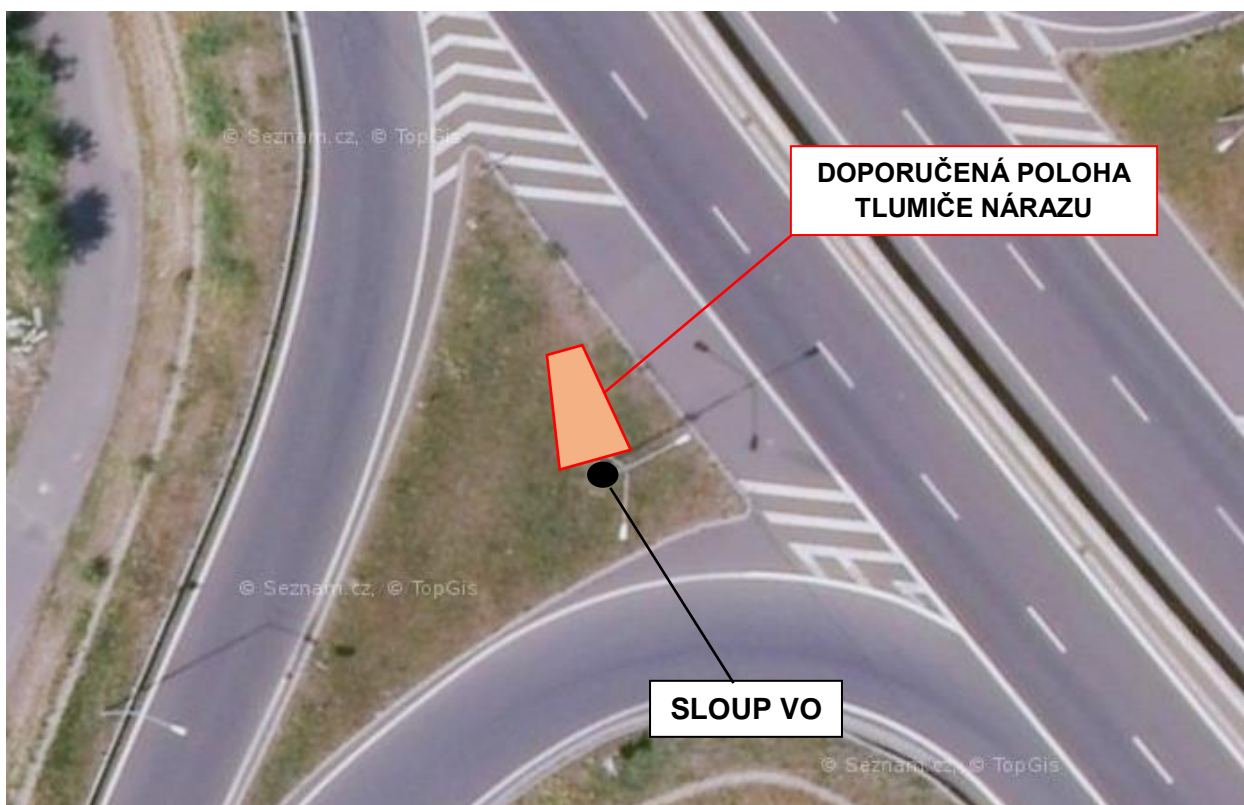
Obrázek 27 – Ukázka doporučené polohy tlumiče nárazu. [1]
