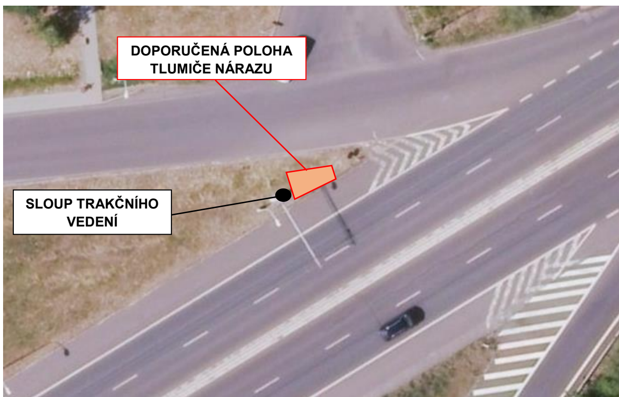
Obrázek 54 – Ukázka doporučené polohy tlumiče nárazu. [1]
