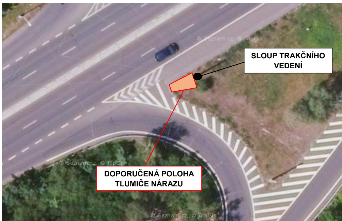
Obrázek 45 – Ukázka doporučené polohy tlumiče nárazu. [1]
