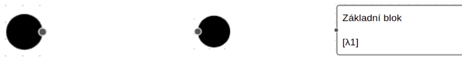
■ Obrázek 4.6 Množina prvků blokového modelu - Počáteční blok, koncový blok a standardní blok představující část modelovaného systému.
