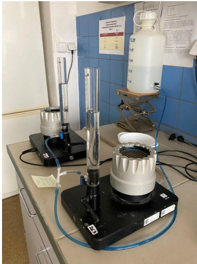
Obrázek 26 Přístroj KSAT použitý pro měření hydraulické nasycené vodivosti
