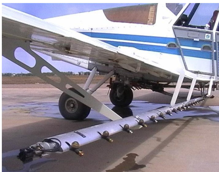
Obr. 1.1.: Lišta vybavená rozprašovacími tryskami zavěšená pod křídlem letadla [2]
