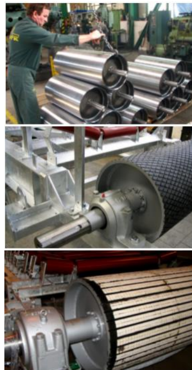
Obrázek 12 Hnací buben: hladký, pogumovaný a obložený [18]
