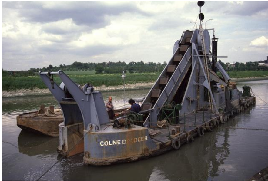
Obrázek 4 Korečkový dopravník na řece [12]
