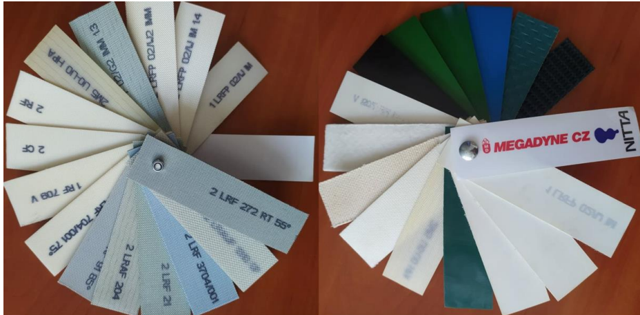
Obrázek 37 Spodní (vlevo) a vrchní (vpravo) vrstvy pásů [autor]
