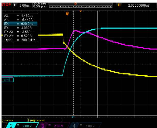
Obrázek 6.12: Napěťová špička na invertujícím vstupu (všechny signály v měřítku 2V/čtverec)
