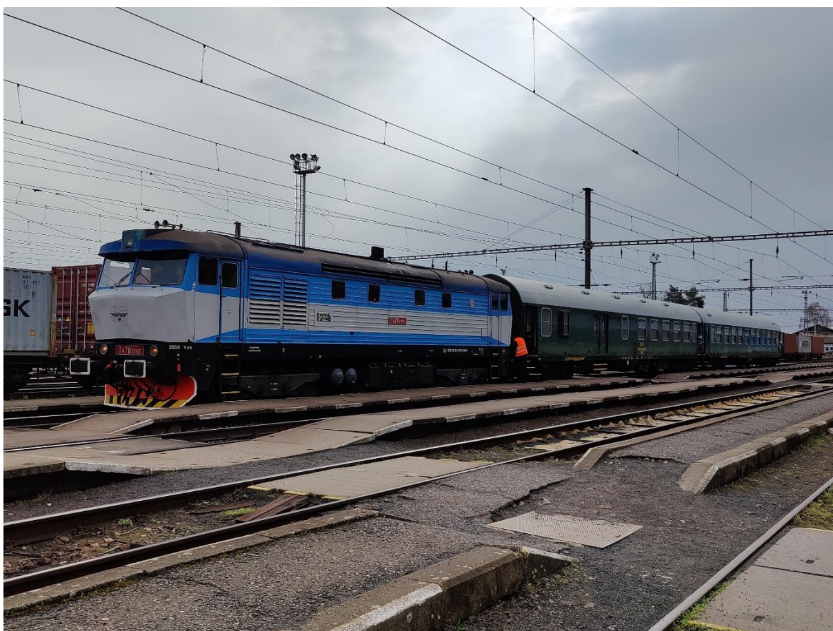
Obrázek 17 Od soupravy Kokořinského rychlíku se odvěšuje lokomotiva, která bude soupravu objíždět, foto vlastní
