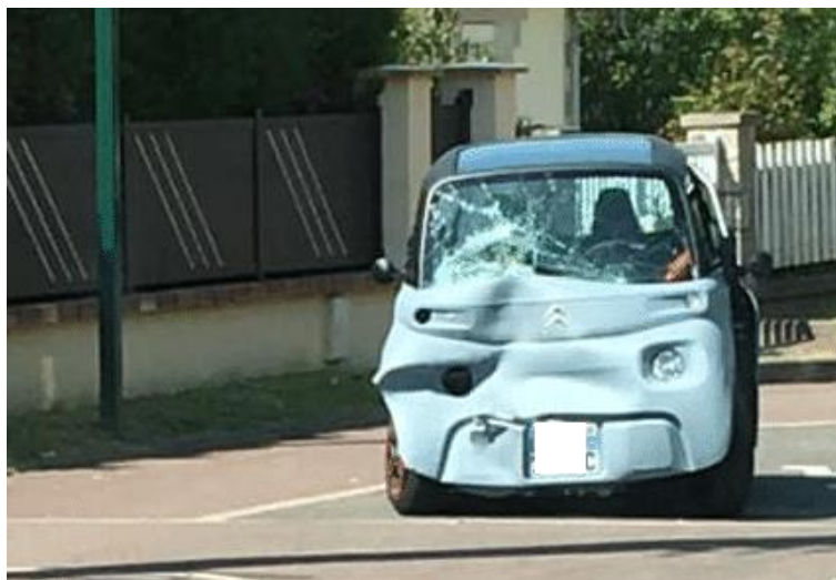
Obrázek 14 - Poškození vozu Ami čelním nárazem [29]
