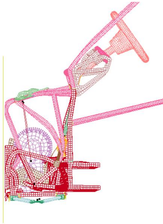
Obrázek 54 - Boční detailní pohled na konstrukci předě po nárazu v 50 km/h
