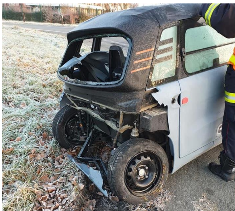
Obrázek 16 - Poškození vozu Ami zadním nárazem [30]
