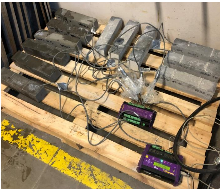
Obr. 5.4: Měření přetvoření od smršťování a dotvarování na vzorcích po ošetřování teplotou.
