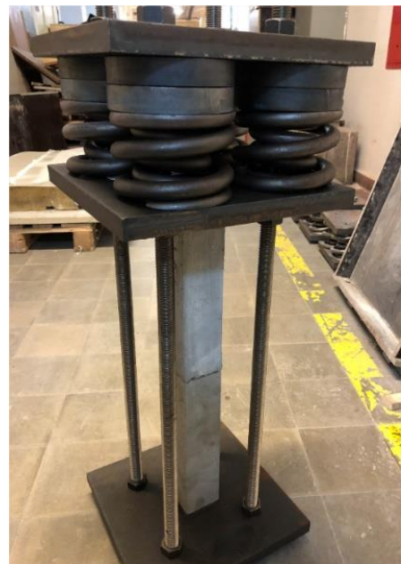
Obr. 5.4: Měření přetvoření od smršťování a dotvarování na vzorcích po ošetřování teplotou.
