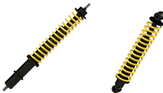
Obrázek 53 - tlumící a pružící jednotky Aixam (přední vlevo, zadní vpravo)
