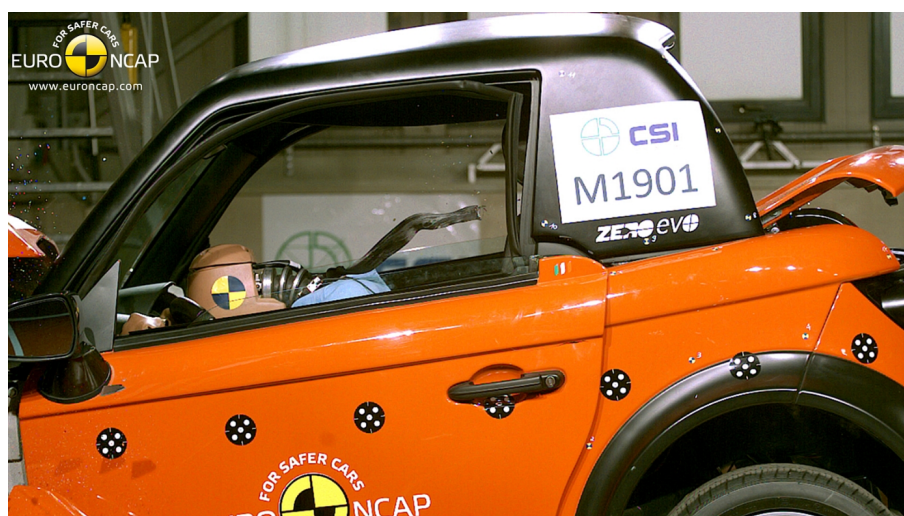
Obrázek 15 - čelní náraz vozidla Tazzari Zero - detail na přetržený bezpečnostní pás [18]
