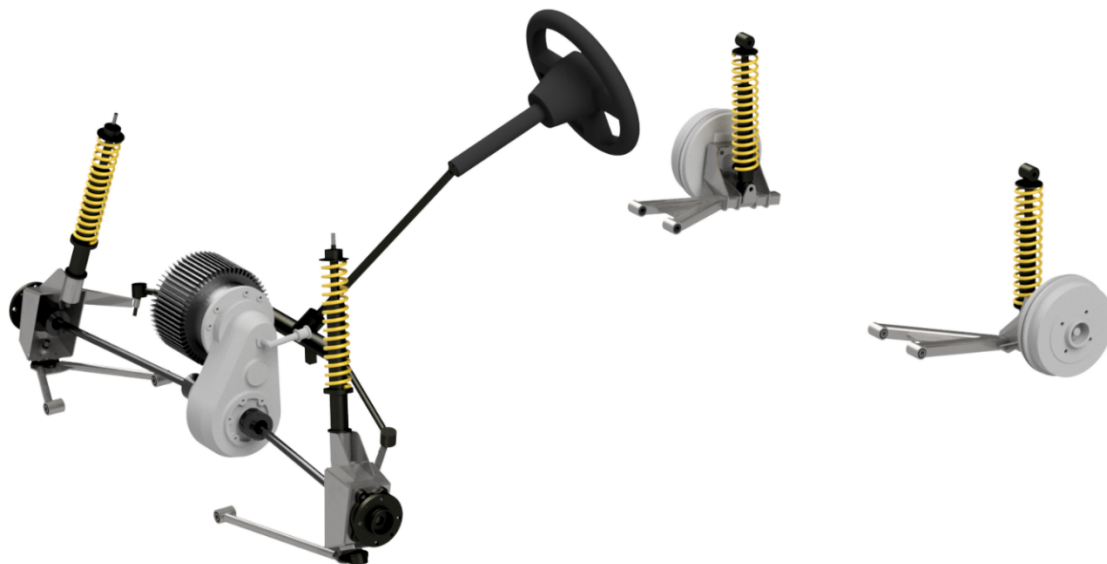
Obrázek 55 - navržené řešení podvozku elektromobilu
