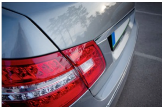
Obrázek 39 - příklad použití polymethylmethakrylátu [6]
