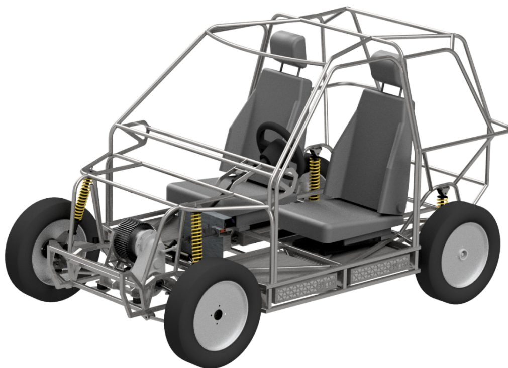
Obrázek 56 - rám podvozku včetně motoru a podvozkových komponentů
