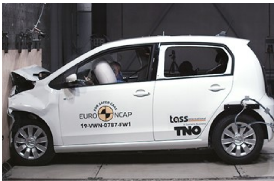
Obrázek 10 – crashtest plná bariéra při 50 km/h [9]
