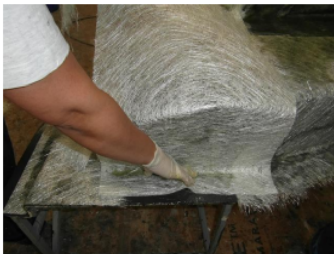
Obrázek 40 - postup vrstvení skelných rohoží při ruční laminaci [32]
