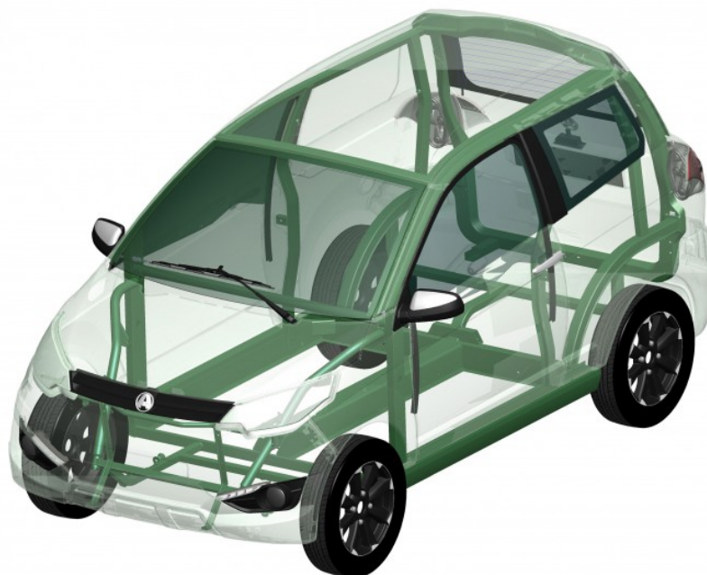
Obrázek 13 - řešení konstrukce rámu karosérie Aixam [22]
