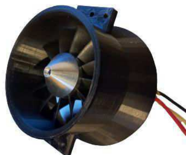
Obrázek 3-15: Vyrobený prototyp 64mm EDF s 12 lopatkovým ventilátorem a parametrem a_w = 1.7 . Zdroj: Autor
