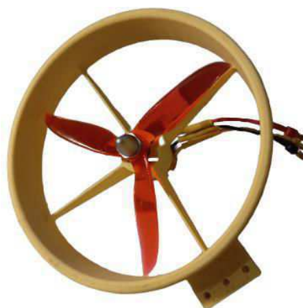
Obrázek 3-26: Vrtule Dalprop Cyclone T5040C umístěná ve vrtulovém krytu s tolerancí 0.3 mm. Zdroj: Autor
