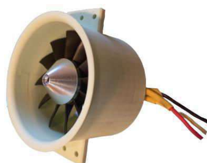
Obrázek 3-2: Vyrobený prototyp 64mm EDF s 12 lopatkovým ventilátorem a parametrem a_w = 1 . Zdroj: Autor
