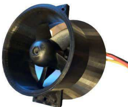
Obrázek 3-18: Vyrobený prototyp 64mm EDF s 5 lopatkovým ventilátorem a parametrem a_w = 1.7 . Zdroj: Autor
