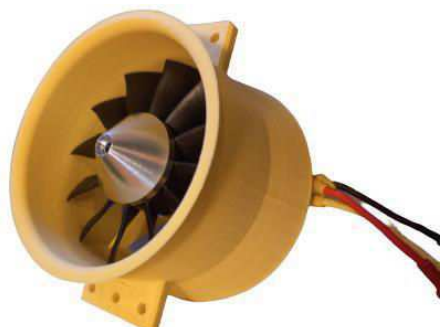
Obrázek 3-14: Vyrobený prototyp 64mm EDF s 12 lopatkovým ventilátorem a parametrem a_w = 1.3 . Zdroj: Autor
