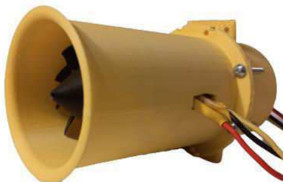
Obrázek 3-34: Dvourotorová specifikace se dvěma 50mm ventilátory a 12 lopatkami. Zdroj: Autor
