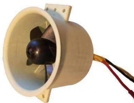
Obrázek 3-5: Vyrobený prototyp 64mm EDF s 5 lopatkovým ventilátorem a parametrem a_w = 1 . Zdroj: Autor
