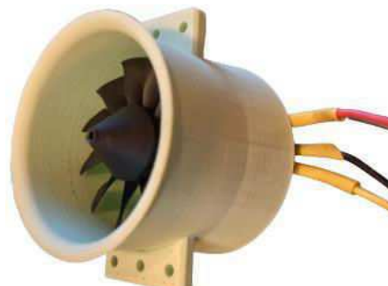
Obrázek 3-9: Vyrobený prototyp 50mm EDF s 12 lopatkovým ventilátorem a parametrem a_w = 1.1 . Zdroj: Autor
