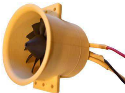
Obrázek 3-1: Vyrobený prototyp 50mm EDF s 12 lopatkovým ventilátorem a parametrem a_w = 1 . Zdroj: Autor
