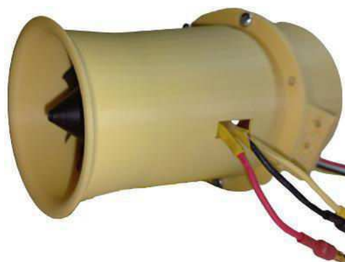
Obrázek 3-35: Dvourotorová specifikace s rozšiřujícím se průřezem. Zdroj: Autor
