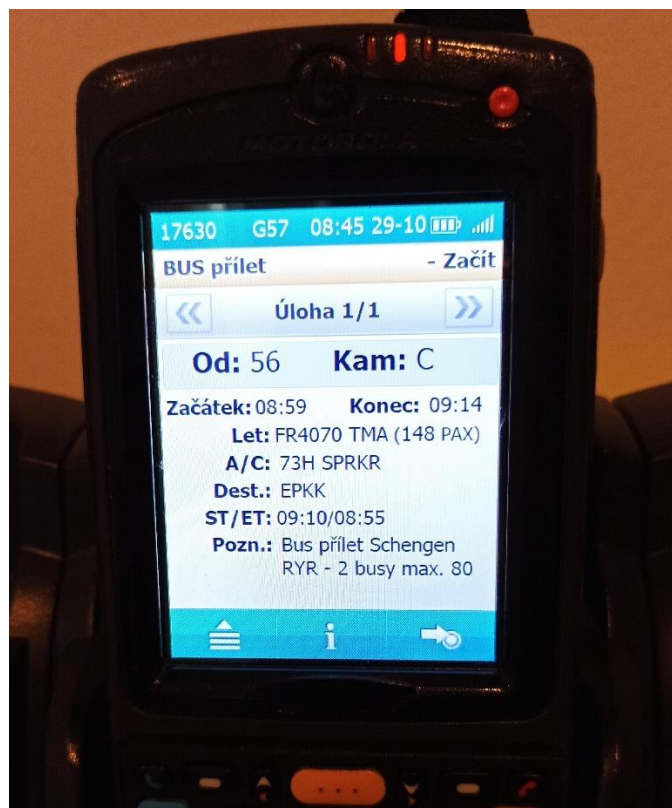
Obrázek 2 - Příklad informací na PDA pro operátora autobusu při příletu na odlehlé stání [zdroj: autor]
