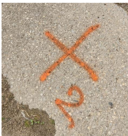
Obrázek 6. Uměle vytvořený vlícovací bod [autor]
