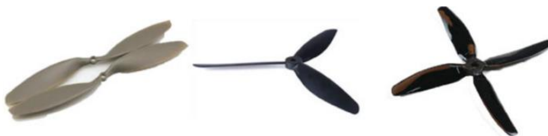
Obrázek 1.18: Vrtule s rozdílnou geometrií a počtem listů [17]
