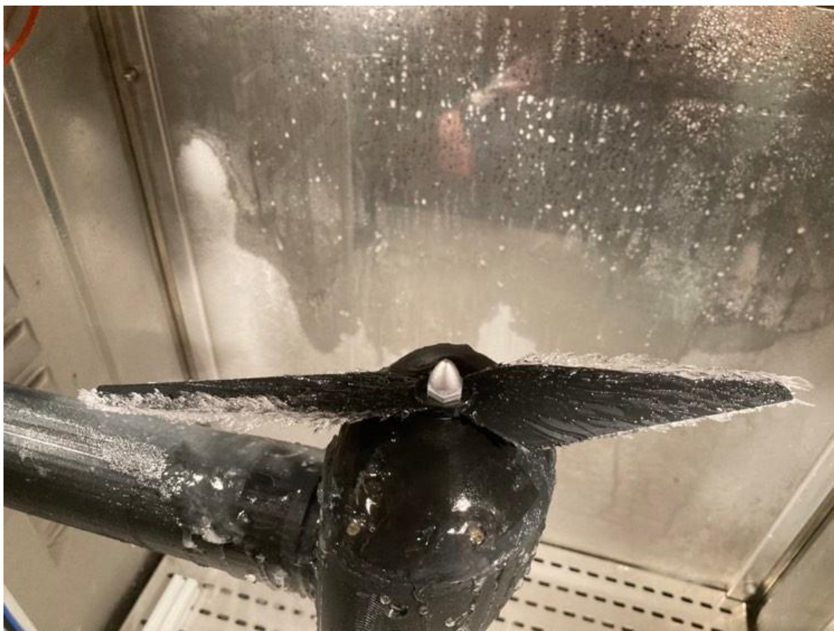
Obrázek 3.5: Námraza vzniklá při -10\text{ }^{\circ}\text{C}
