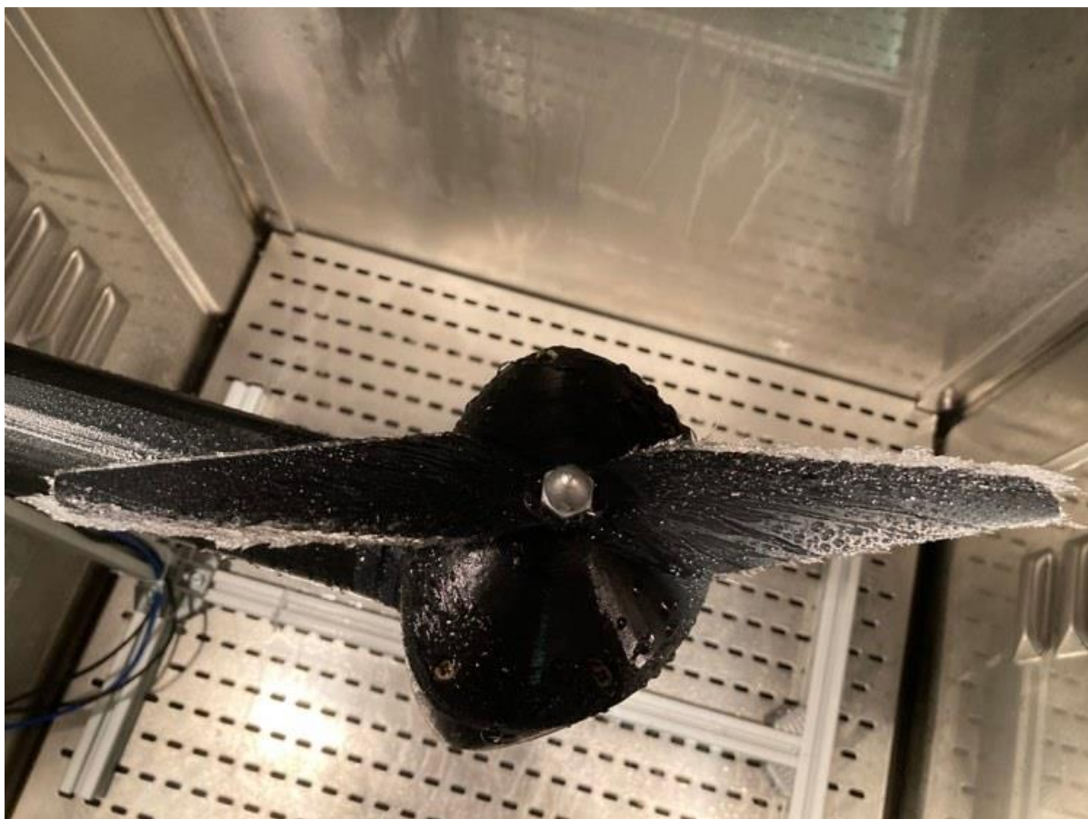
Obrázek 3.4: Námraza vzniklá při -5 °C
