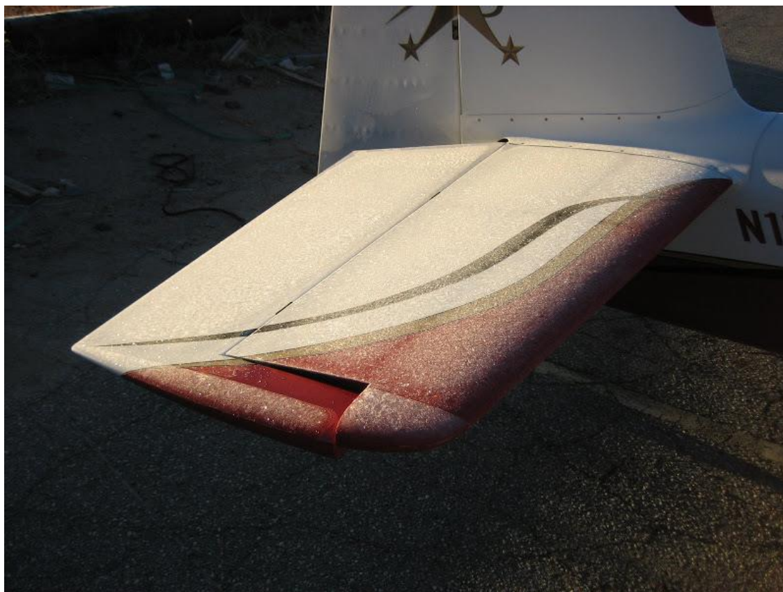
Obrázek 1.4: Jinovatka na ocasních plochách [8]
