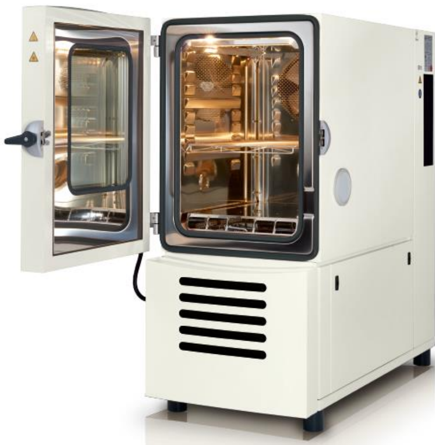
Obrázek 2.2: Klimatická komora FSv ČVUT
