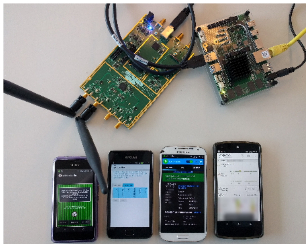
■ Obr. 3.4 Mobilné zariadenia komunikujúce so zariadením využívajúcim USRP [45]
