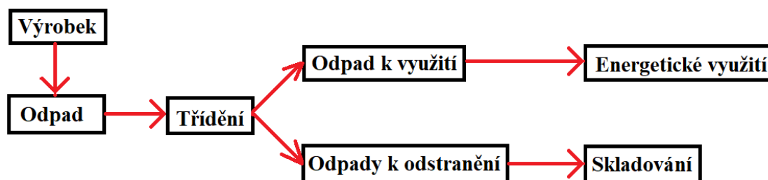
Obrázek 5. Schéma nakládání s odpadem
