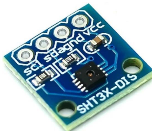
Obr. 5.10 Senzor teploty a vlhkosti vzduchu SHT30 (převzato z [30])
