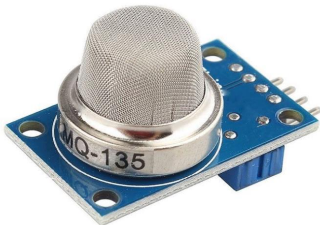
Obr. 5.9 Modul se senzorem MQ-135 (převzato z [29])
