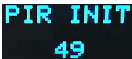
Obr. 5.17 Odpočet na displeji při inicializaci PIR detektoru
