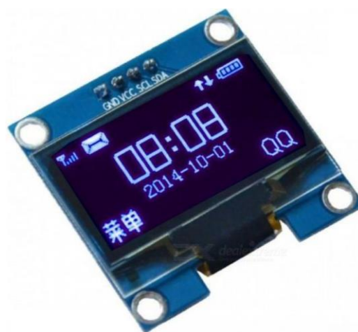
Obr. 5.15 Displej OLED 0,96“ (převzato z [31])
