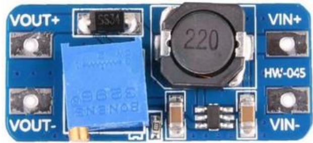
Obr. 5.4 Step-up měnič s MT3608 (převzato z [23])
