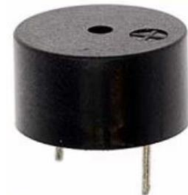
Obr. 5.13 Piezobzučák (převzato z [27])
