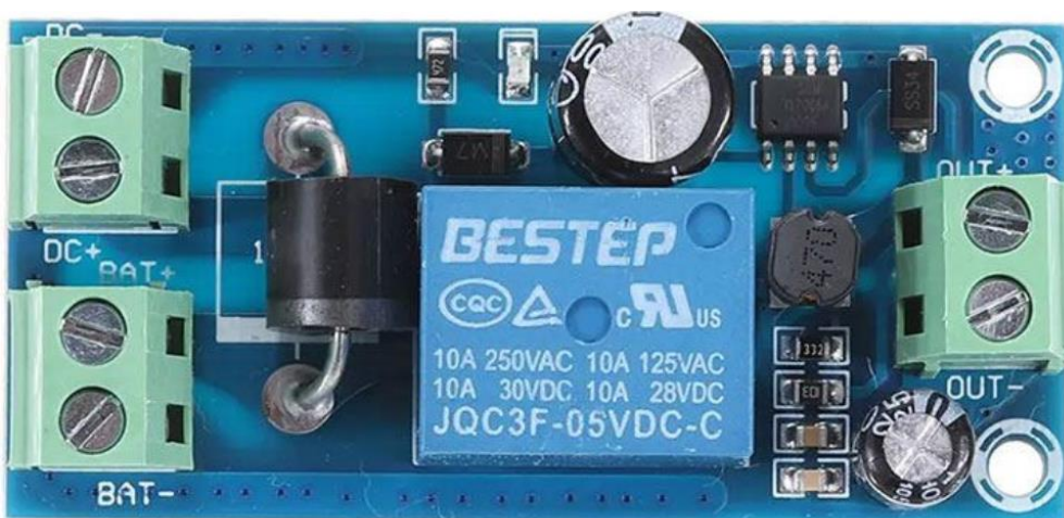
Obr. 5.5 Automatický přepínač baterie (převzato z [25])
