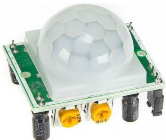
Obr. 5.14 Detektor pohybu, PIR NC-SR501 (převzato z [26])
