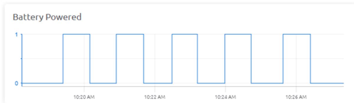
Obr. 6.1 Testování funkčnosti zálohy napájení
