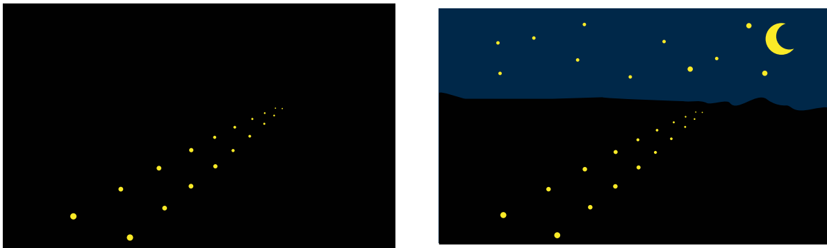
(a) Prostředí bez viditelného horizontu a vizuálních referencí. (b) Stejný obrázek s viditelným horizontem zvyšující povědomí o orientaci dráhy.
