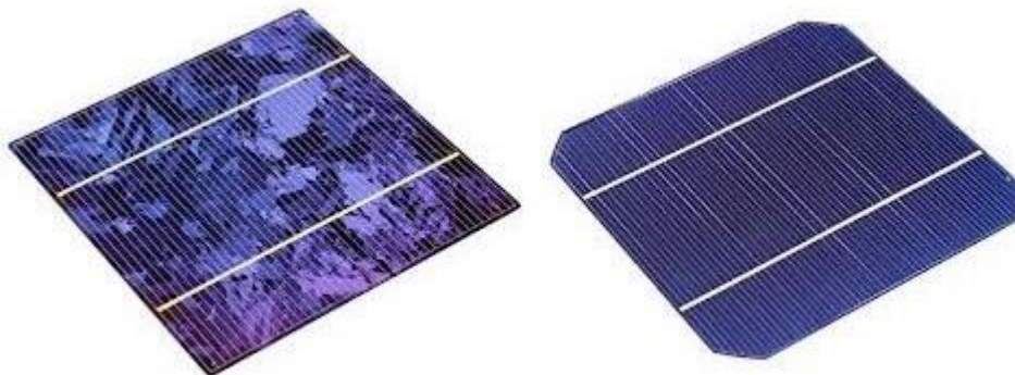
Obr. 4: Polykrystalický (vlevo) a monokrystalický článek
