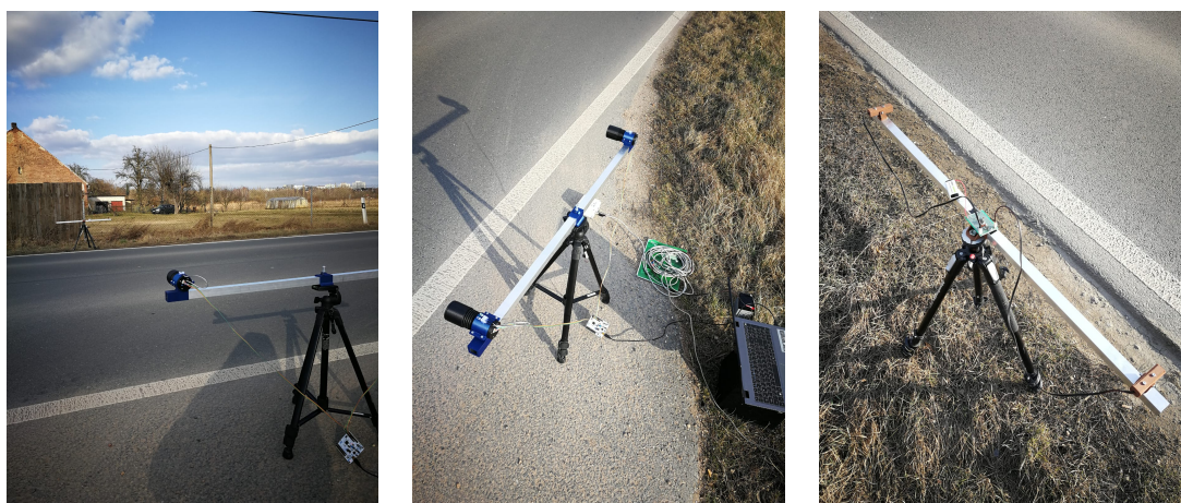
(a) Pohled na celou vozovku s optickou závorou
