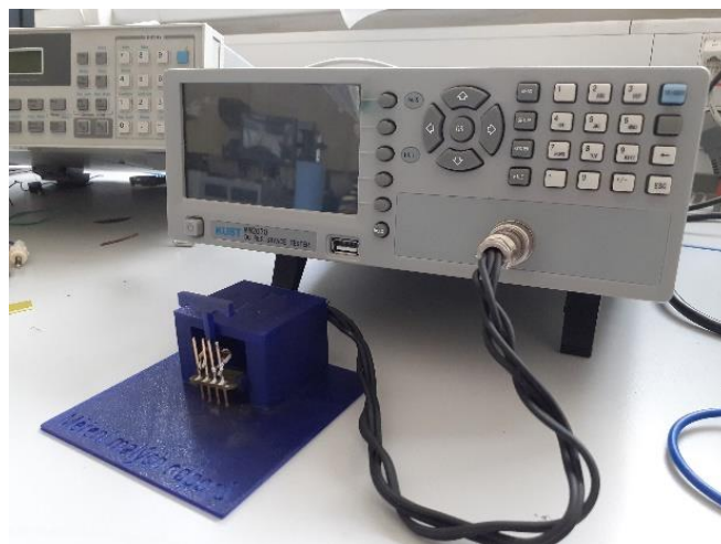
Obr. 31: KUST DC RESISTANCE TESTER MM2030 s přípravkem pro měření malých odporů
