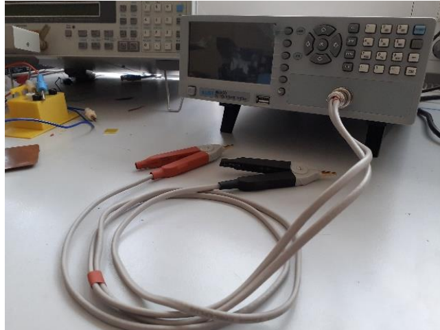
Obr. 32: KUST DC RESISTANCE TESTER MM2030 s měřicími kleštěmi
