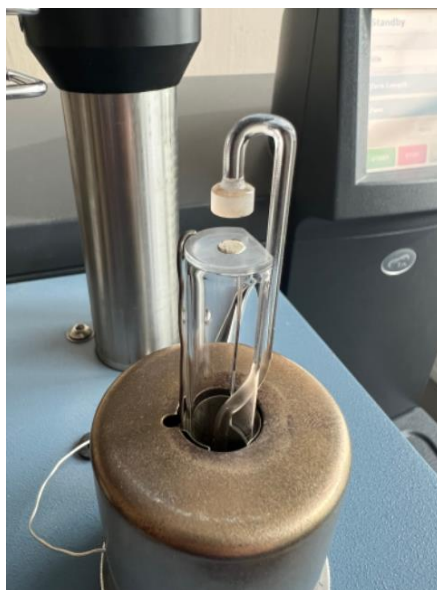
Obr. 29: Detail sondy a vzorku umístěného na stage Q400 TMA
