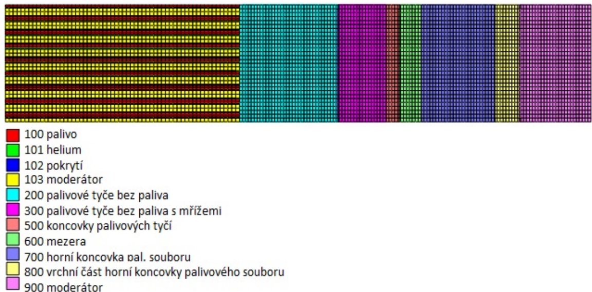
Obr. 2.11: Horní axiální reflektor tlakovodního reaktoru NuScale s aproximací palivového souboru v axiálním řezu
