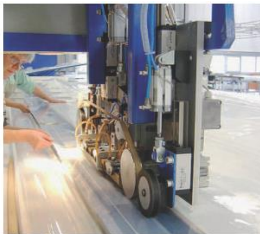
Obr. 54. Ukázka průmyslového stroje určeného pro svařování vysokou frekvencí [11]
