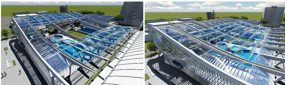
Obr. 83. Simulace pohybu řetězových ploch z vícevrstvé ETFE Folie
