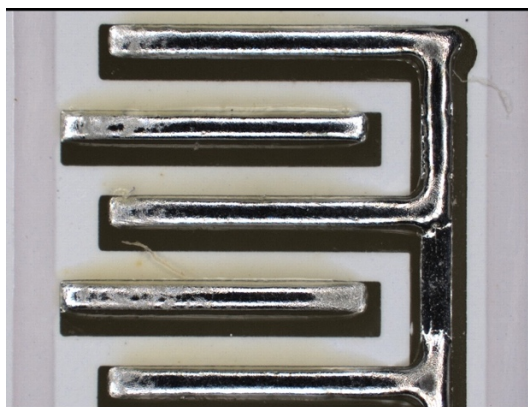
Obrázek 27: Typ U s bílou maskou, s pájecí pastou a zbytky tavidla
