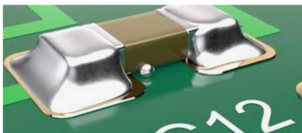
Obrázek 7: Solder beading. Převzato z [26]
