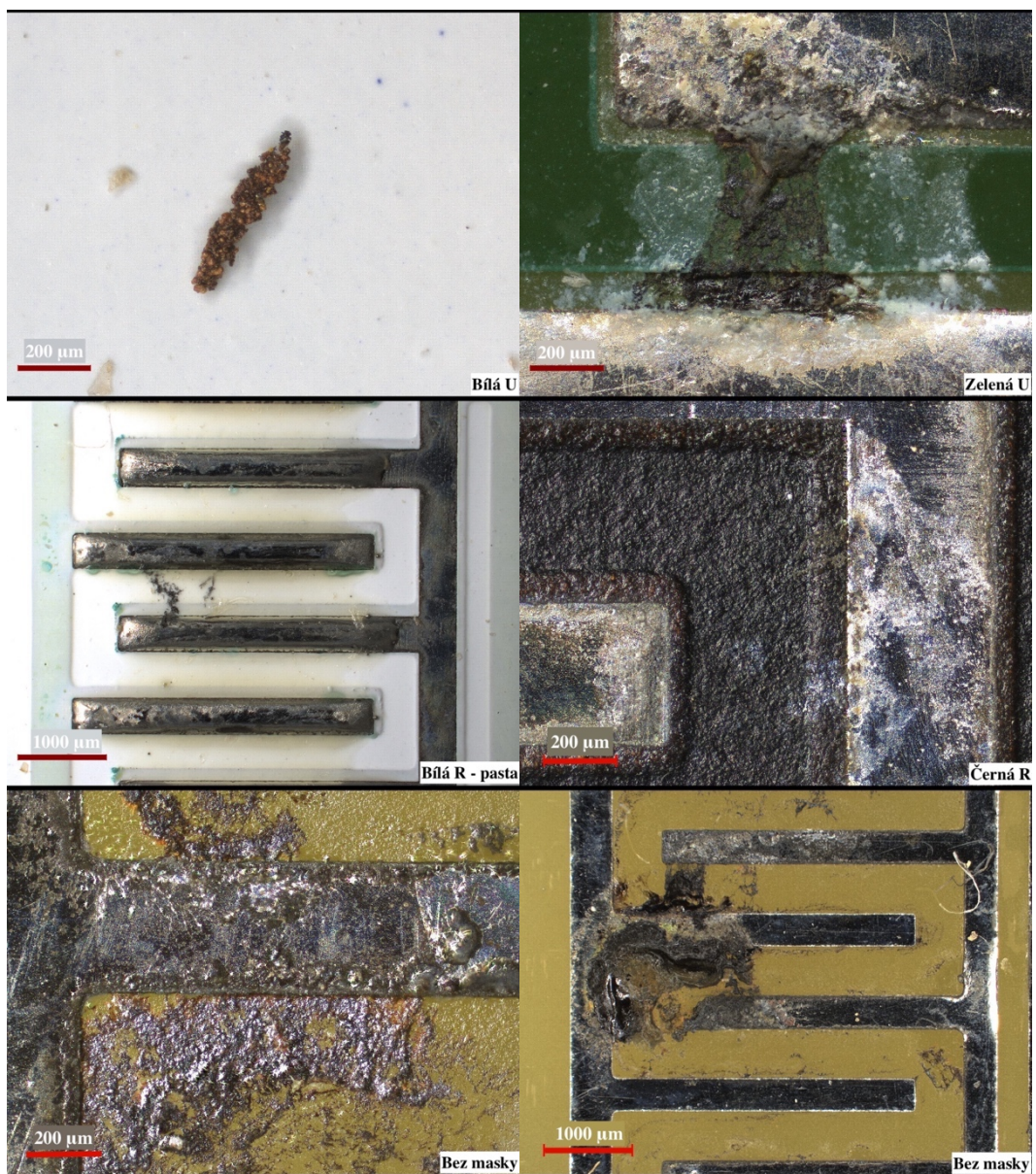
Obrázek 39: Ukázka dendritů vzniklých během THBT testu
