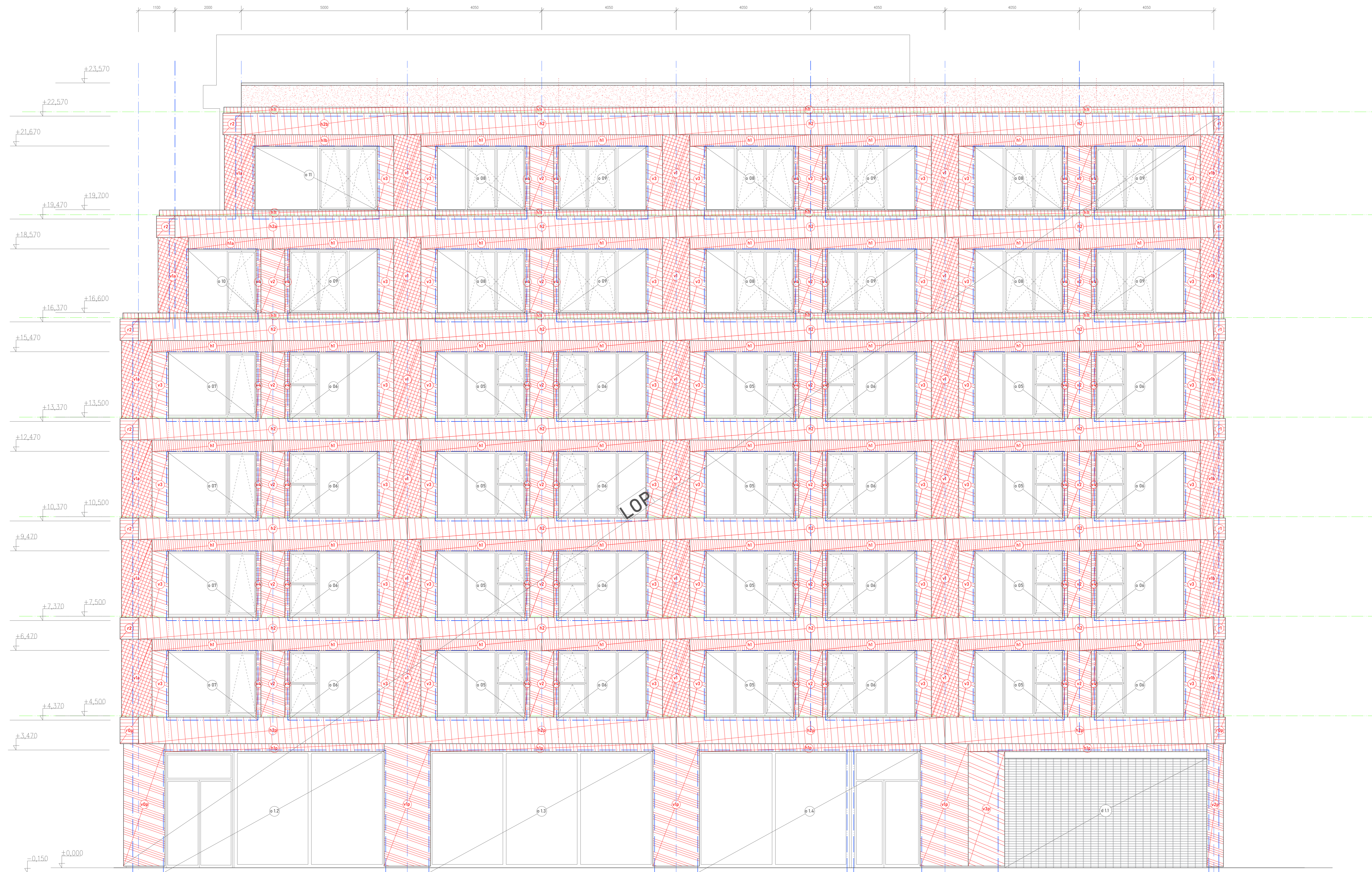
Hliníková modulová fasáda Schuco AF UDC 80 Materiál: hliník - RAL 7021, průřekování tepelné technické vlast. - U=0,76 W/m²K
