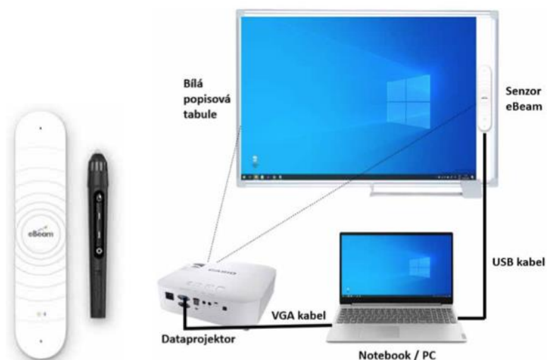
Obrázek 2. Sestava mobilní interaktivní tabule eBeam – senzor + interaktivní pero (Kopecký, 2021)
