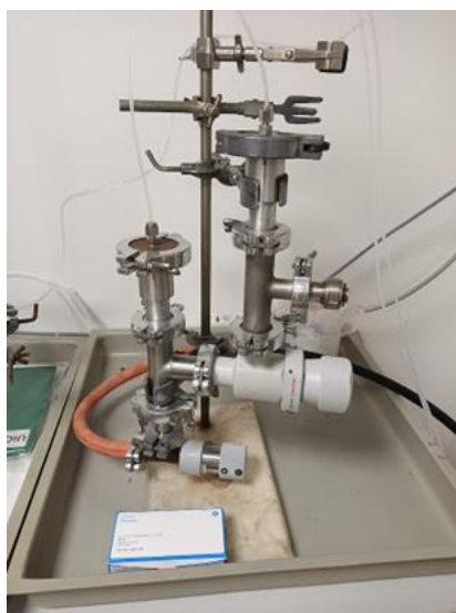
Obrázek č. 13 – Aparatura pro záchyt aerosolů na filtr ze skleněných mikrovláken [43]
