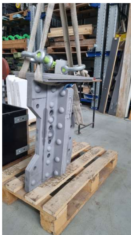
Obrázek 4.6: Fotografie hlavního vzorku D - po vytvoření prostupů a odříznutí zadní části stojiny
