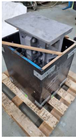
Obrázek 4.9: Bednění s hlavním vzorkem
