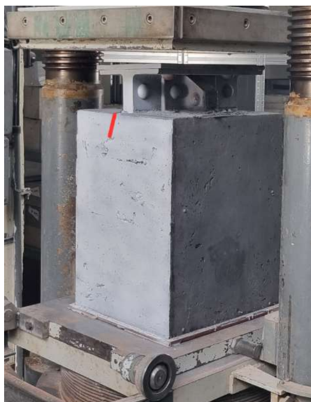
Obrázek 5.48: Vzorek D po zatěžovací zkoušce
