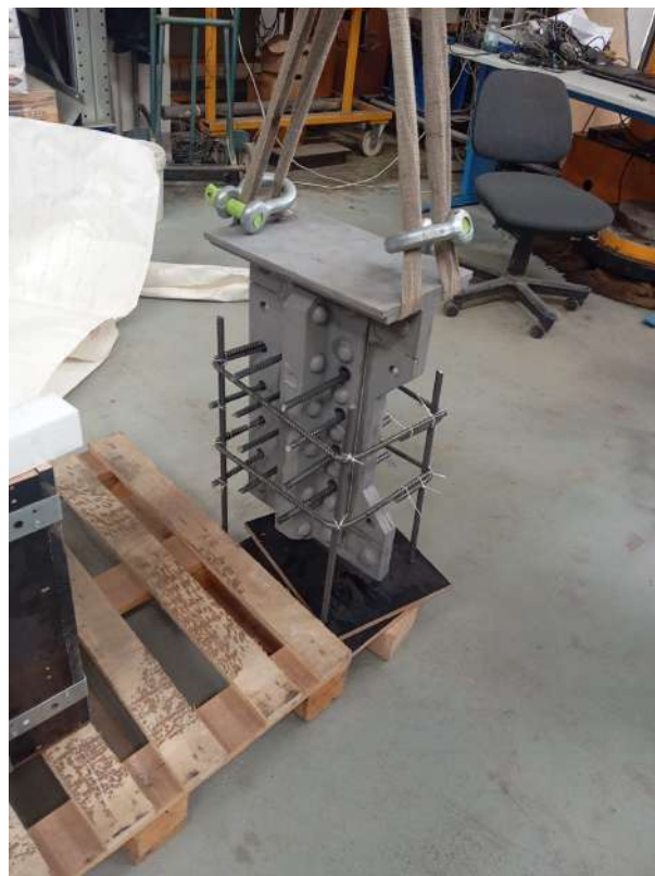
Obrázek 4.8: Hlavní vzorek s výztužnými pruty
