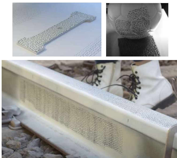
Obrázek 5.16: Aplikace vzoru na zkušební tělesa
