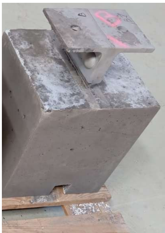
Obrázek 5.29: Fotografie vzorku B1 – před provedením zkoušky
