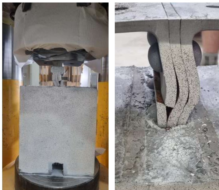
Obrázek 5.23: Vzorek C1 po protlačovací zkoušce
