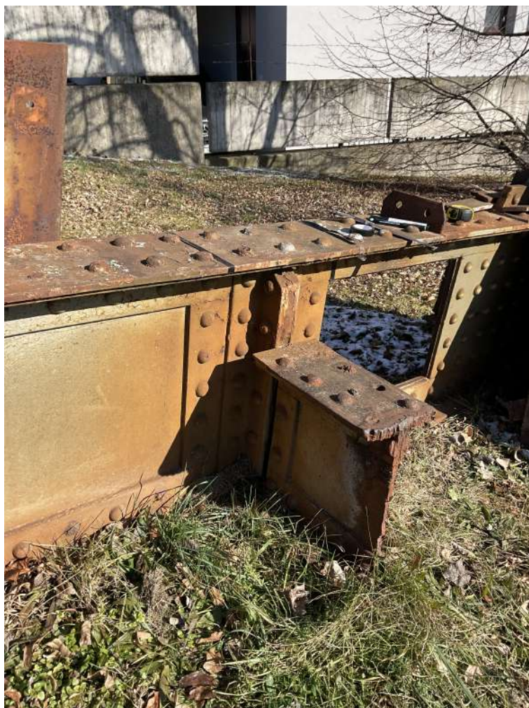
Obrázek 5.2: Část konstrukce zvolená pro vzorek typu D
