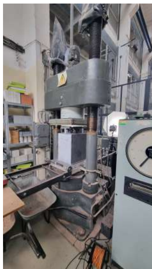
Obrázek 5.47: Mechanický lis s uloženým vzorkem D
