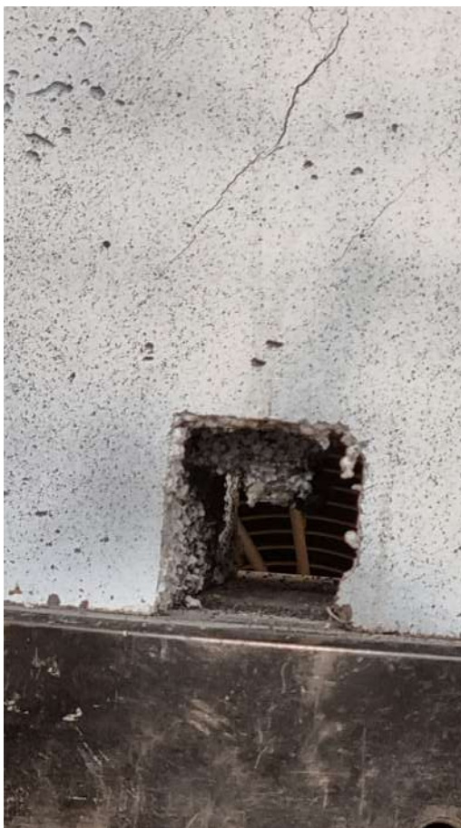
Obrázek 5.37: Fotografie prokluzu vzorku B3 – po provedení zkoušky
