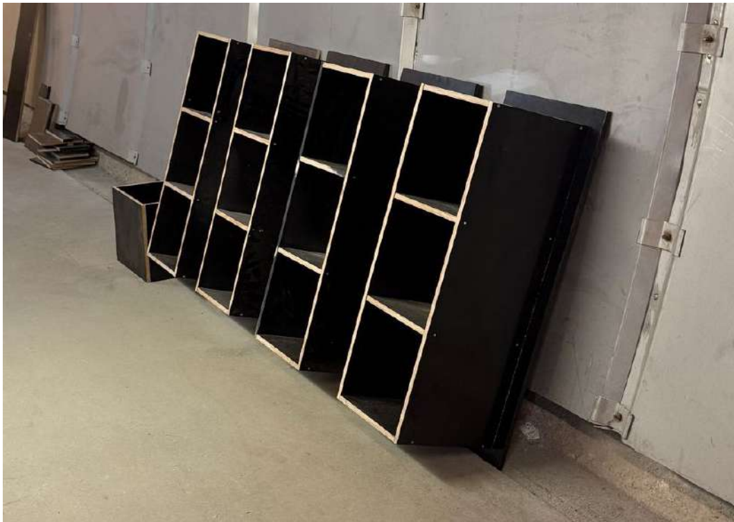
Obrázek 5.6: Připravené bednění pro zkušební tělesa
