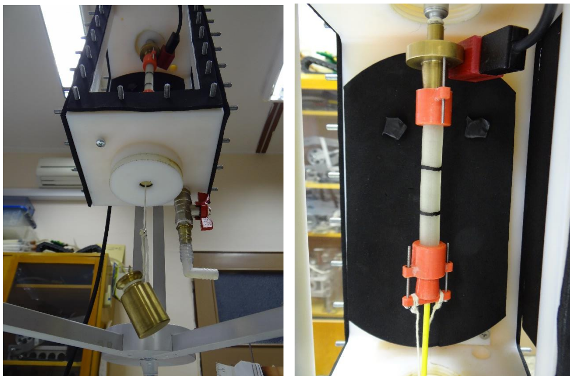
Obrázek 5: Princip zavěšení axiálního závaží vlevo, Tubulární vzorek upnutý mezi upínací trny vpravo
