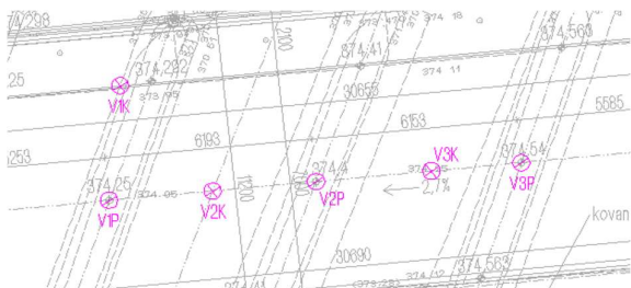
Obr. 136: Místa odběru vzorků, Obr. 137: Odebrané vzorky z nosné konstrukce pro laboratorní analýzu
