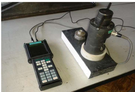
Obr. 99: Zkoušení přilnavosti v tahu pomocí odtahového přístroje Comtest OP 3/4
