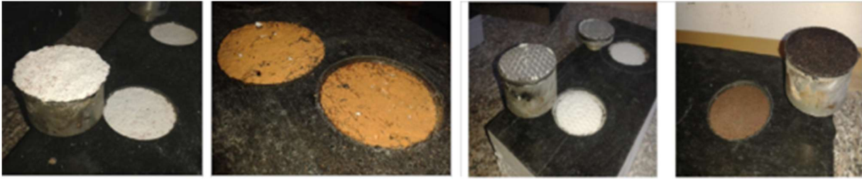
Obr. 100: Koheze porušení podkladu, PB, Obr. 101: Kohezní porušení podkladu CPP, Obr. 102: (podkladem - XPS a hydroizolace), porušení adheze mezi materiály, Obr. 103: Beton a hydroizolace
