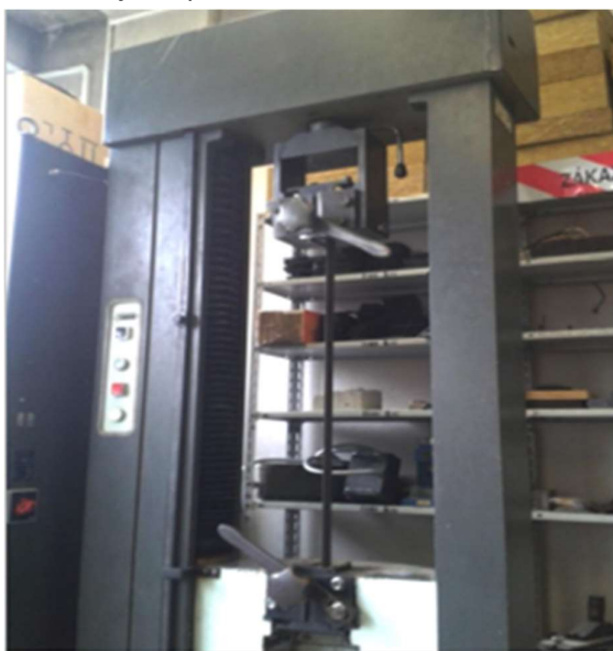
Obr. 97: Experimentální zjištění pevnosti v tahu, Fsv ČVUT v Praze
