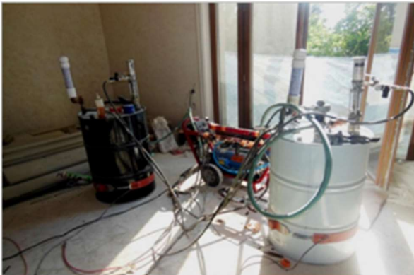
Obr. 93: Vysokotlaké aplikační zařízení
