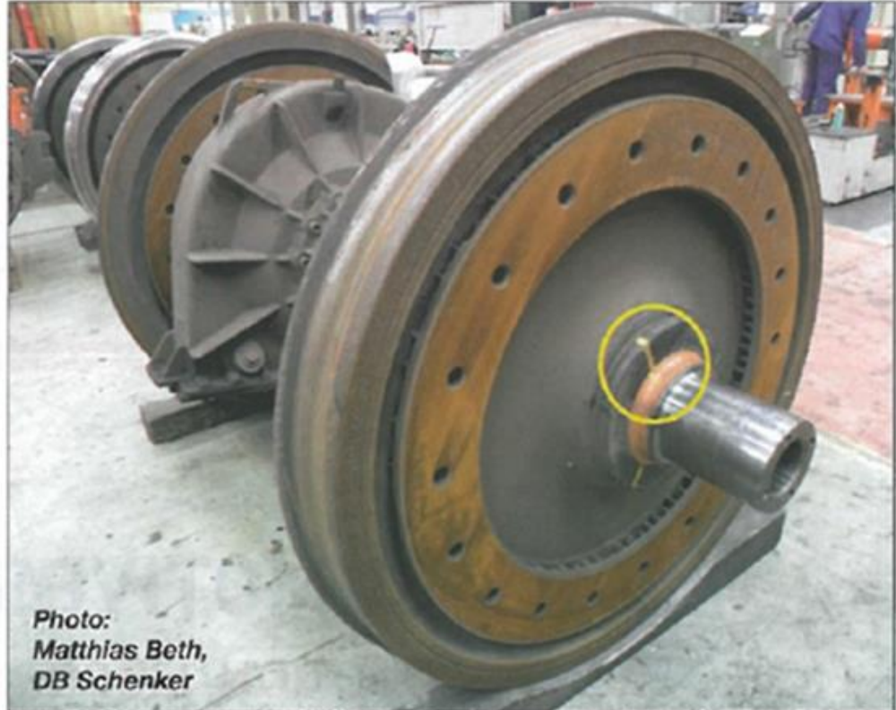
Obr. 1 Dvojkolí lokomotivy TRAXX s detailem závady – dáno nesouhlasící polohou žlutých indikačních značek na nápravě a náboji kola. [1]
