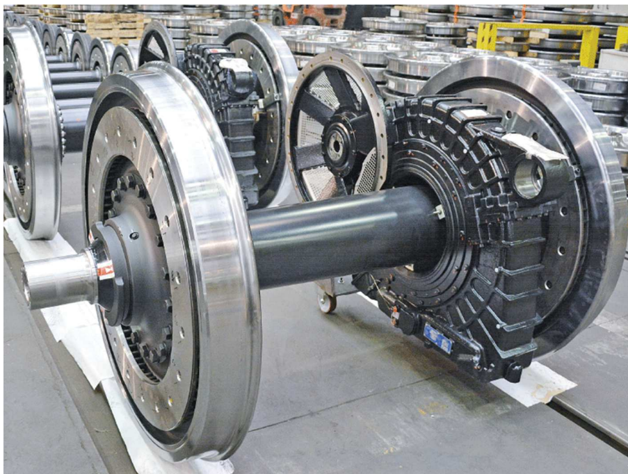
Obr. 2-33 Pohled na kompletní dvojkolím se zcela odpruženým pohonem převodovka je s dvojkolím spojena prostřednictvím spojky – duté hřídele. [51]
