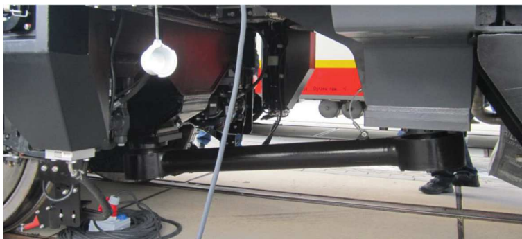
Obr. 2-36 Detail propojení tažné tyče na skříň a rám podvozku (zdroj: vlastní foto autora)
