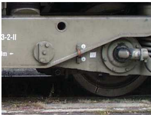
Obr. 2-31 Univerzální podvozek ČKD lokomotivy řady 720 (T 435.0), vedení dvojkolí řešeno kyvným ramenem [47]
