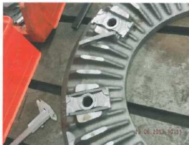
Obr. 2-19 Pohled na brzdový kotouč s detailem montážního rozhraní. [16]
