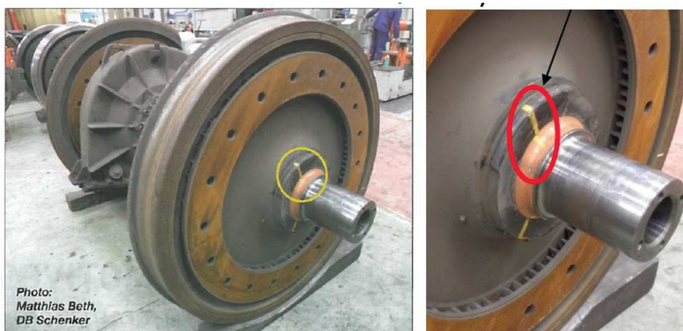
Obr. 2-1 Vpravo dvojkolí lokomotivy TRAXX s vyznačením výskytu závady. Vlevo detail kola pootočeného vůči nápravě [7]
