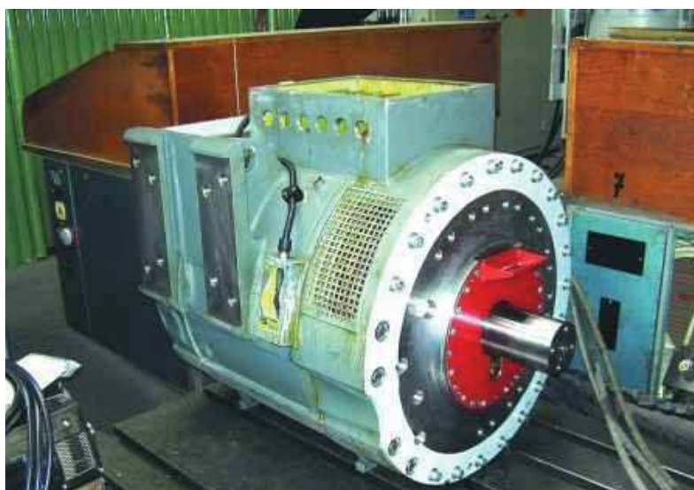
Obr. 2-43 Trakční motor Škoda ML 4550 K/6 použitý v lokomotivách řady 380. Jmenovitý výkon motoru je 1600 kW [27]
