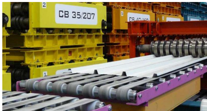
Obrázek 3 - Příklad válcování plošného profilu [10]
