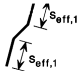
Obrázek 16 - Definice průřezu pro výpočet I_s [1]
