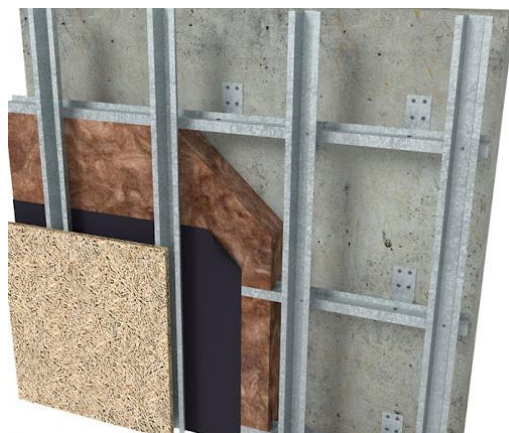
Obr. 1: Příklad skladby provětrané fasády [5]
