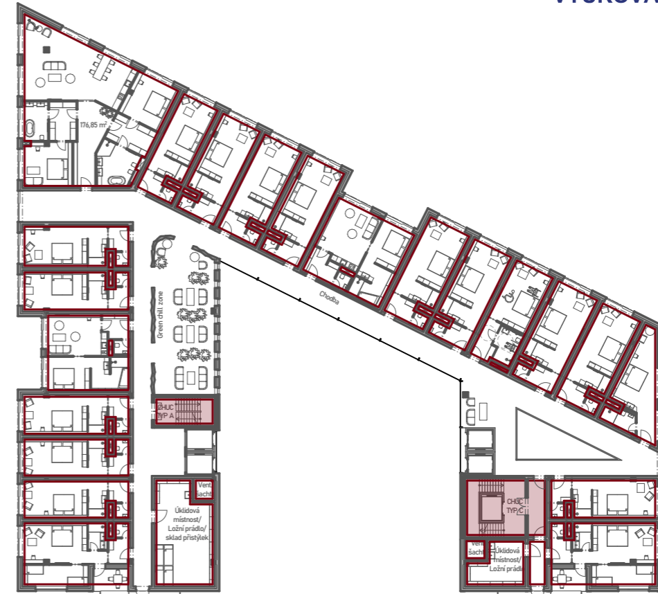
Rozdělení požárních úseku, vyznačení CHÚC - Typické podlaží
