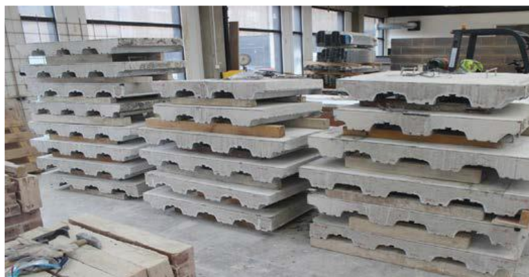
Obr. 25 - Prefabrikované stropní panely z trapézového plechu a betonové vrstvy vyztužené KARI sítí [36]
