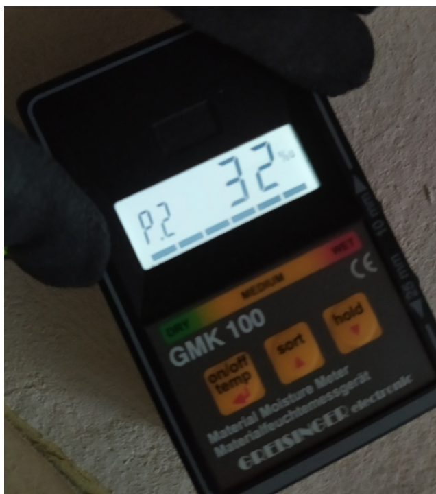
Obrázek číslo 1.50 – Přístroj na měření vlhkosti - GREISINGER electronic GMK 100
