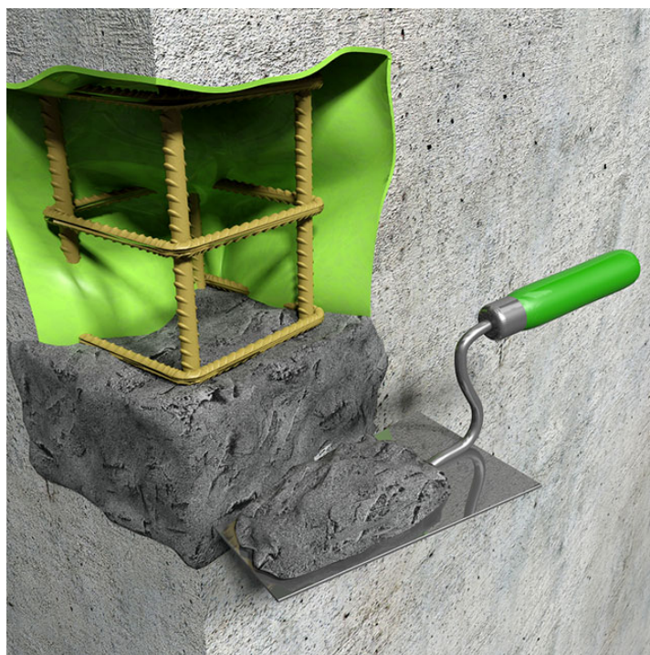
Obrázek číslo 1.75 – sanace krycí vrstvy výztuž [11]
