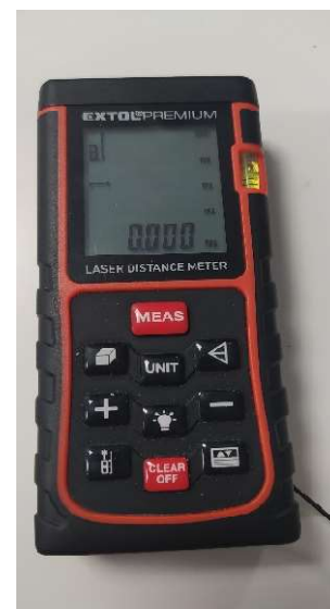
Obrázek číslo 1.6 - Laserový měřák vzdálenosti
