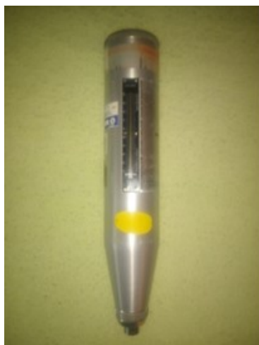
Obrázek číslo 1.87 – Schmidův tvrdoměr typ N
