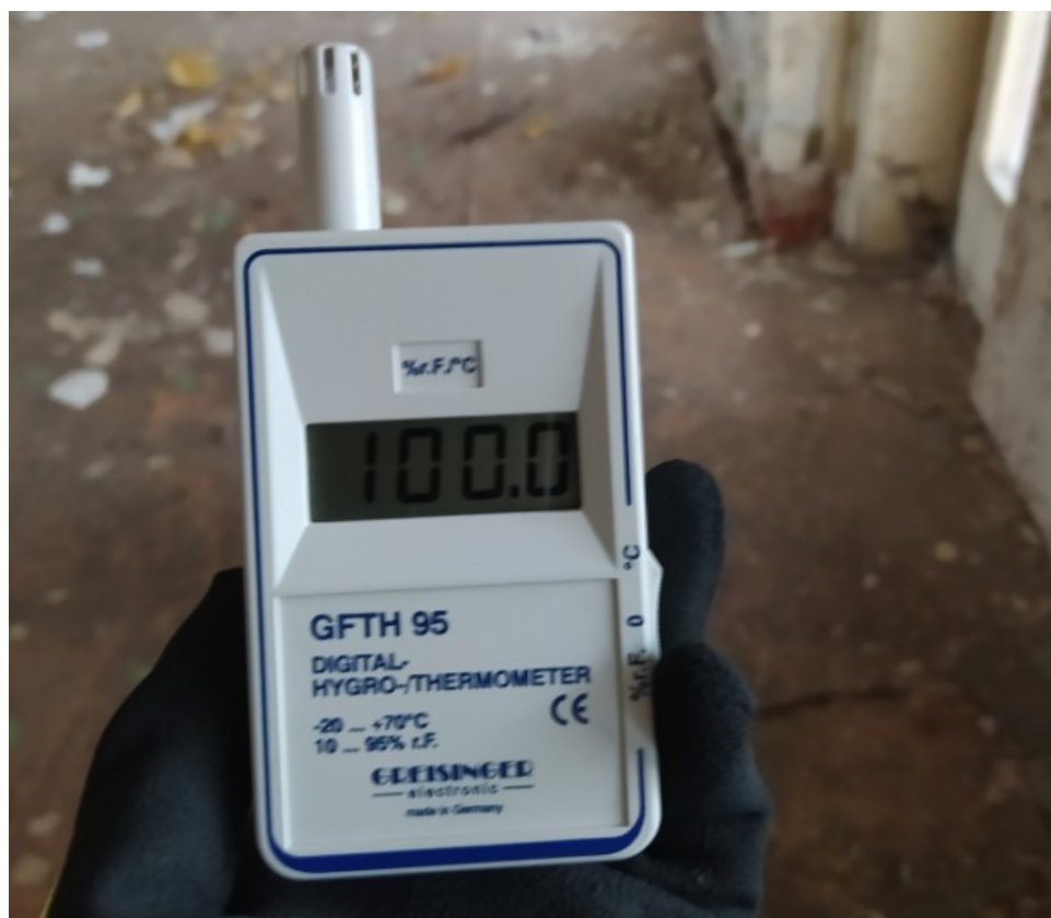
Obrázek číslo 1.49 – Příklad přístroje na měření relativní vlhkosti vzduchu a teploty ve vnitřním prostředí – GREISINGER electronic GFTH 95
