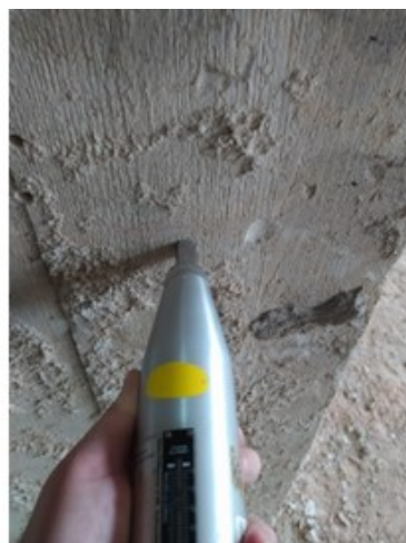
Obrázek číslo 1.88 – Měření pomocí Schmidtova tvrdoměru in situ
