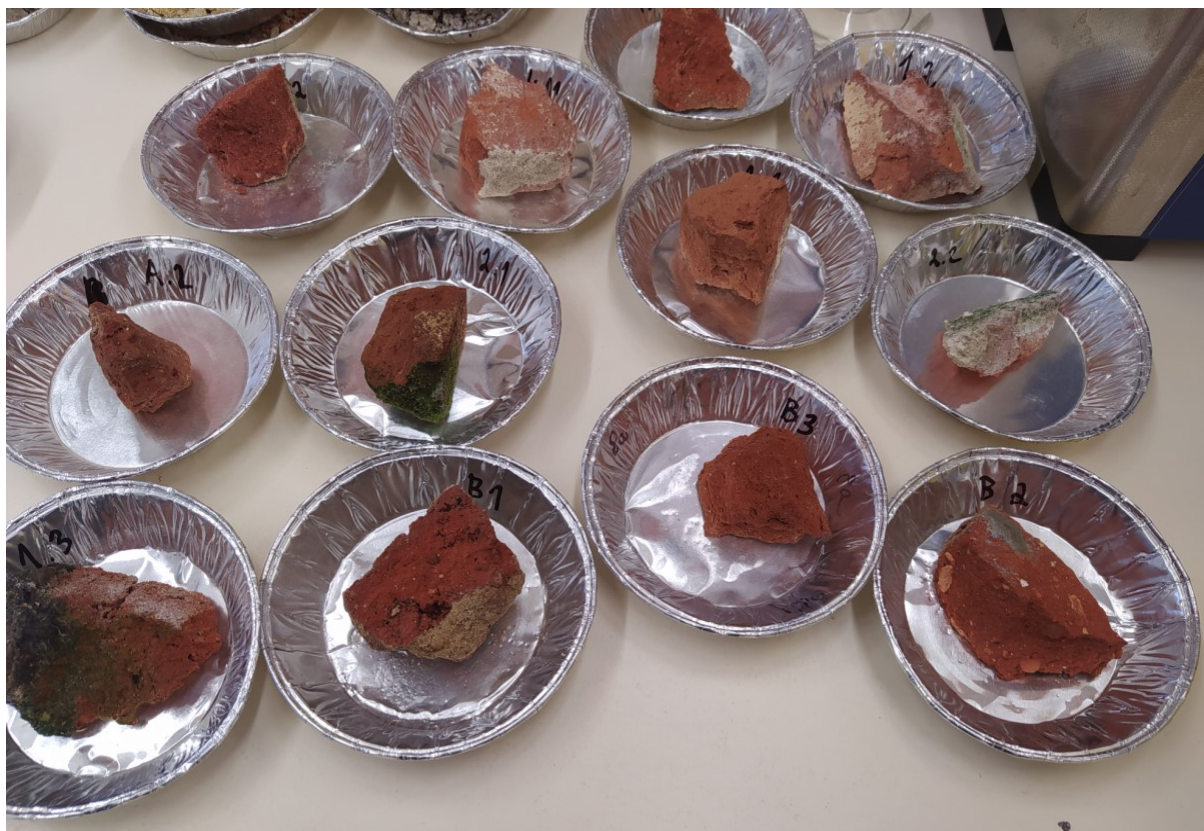
Obrázek číslo 1.51 – Odebrané vzorky pro měření gravimetrickou metodou
