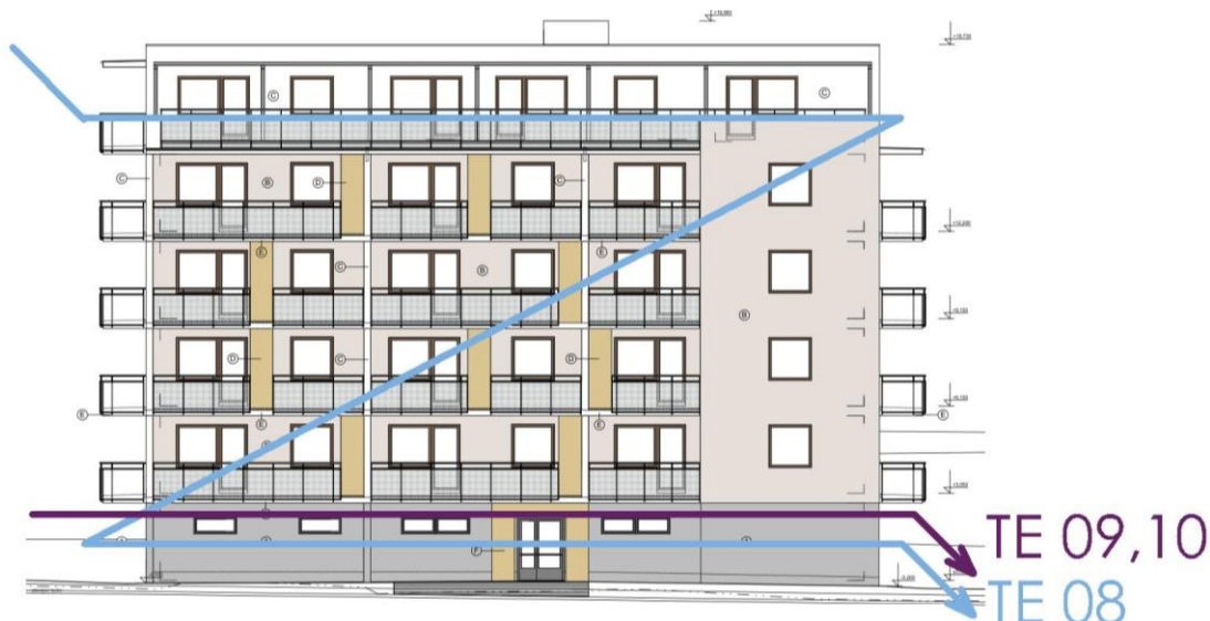
Obr. 4 Schéma postupu 8.,9. a 10.TE [autor práce]
