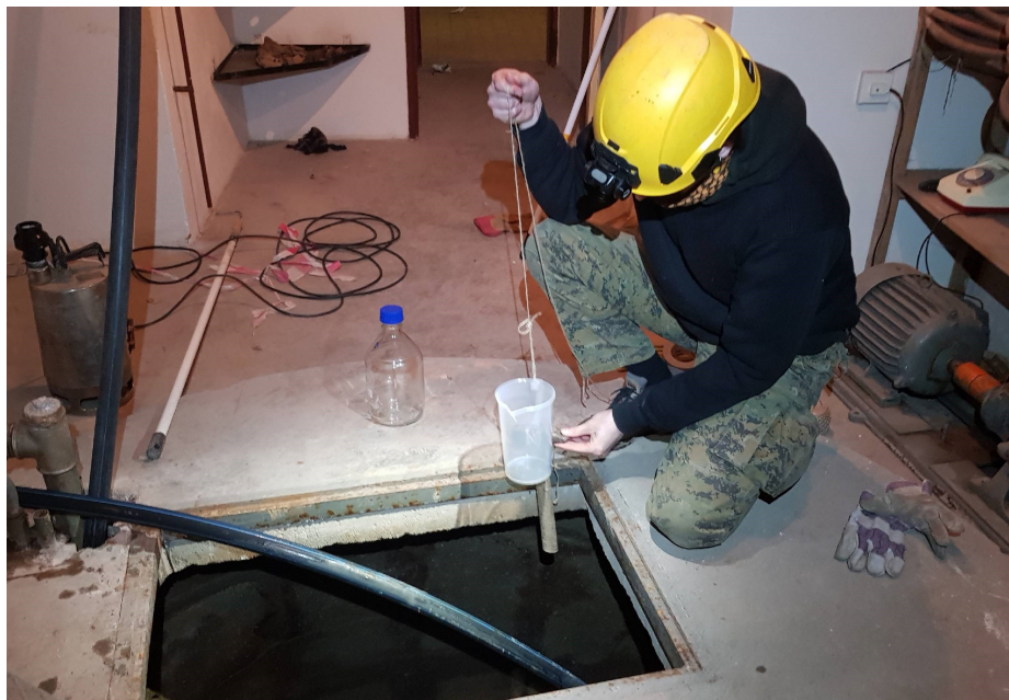
Obr. 23: Odběr vzorků vody ze studny v krytu civilní obrany (Josef Řehák)
