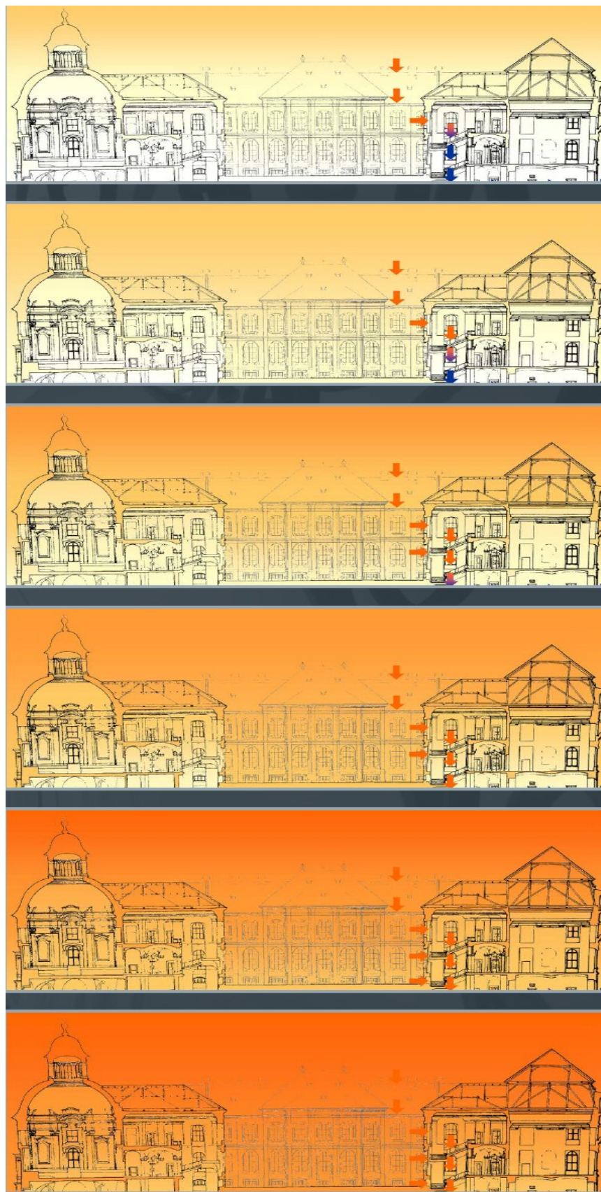
Obr. 19: Klášter Plasy – větrání a prohřívání konventu zabraňující povrchové kondenzaci na masivních konstrukcích v jarních měsících (P. Duchoň)
