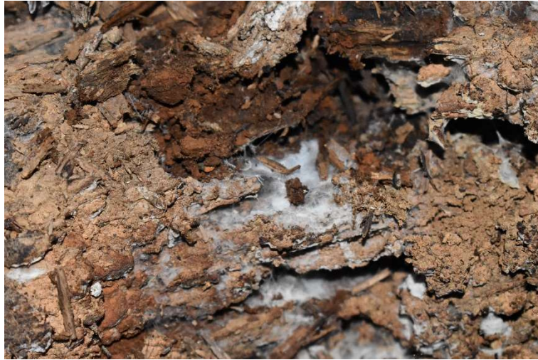
Obr. 76 – Bílá vlákna signalizující výskyt dřevokazných hub
