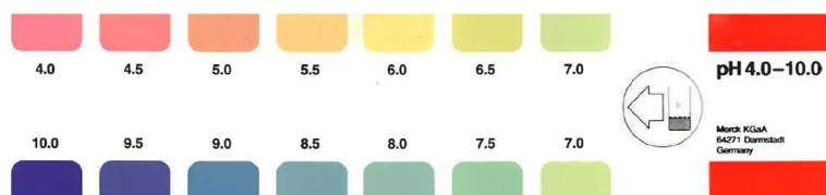
Obr. 67 – Stupnice pH společnosti Merck použitá pro kolorimetrický odhad
