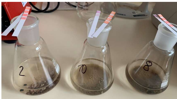
Obr. 68 – Laboratorní stanovení salinity pomocí kvalitativní analýzy
