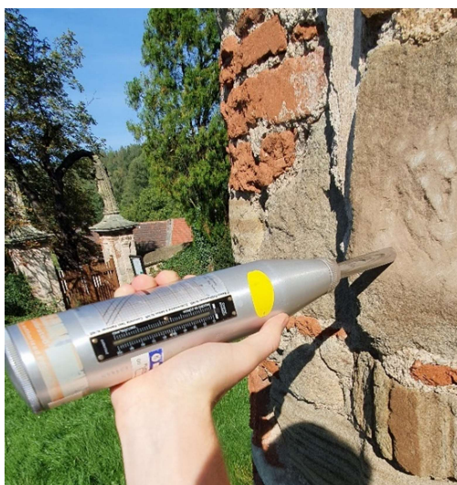
Obrázek 72 - Měření pevnosti na pískovcovém kvádru - vlastní foto
