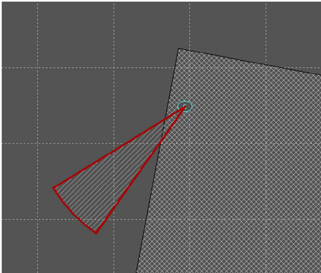
Obr. 27: Výseče dopadu slunečních paprsků do kontrolního bodu – výřez ze softwaru SVĚTLO+ [13]
