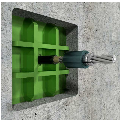
Obr. 50 (vlevo) – 3D schéma kotvení pomocí ocelové roznášecí desky [10]
