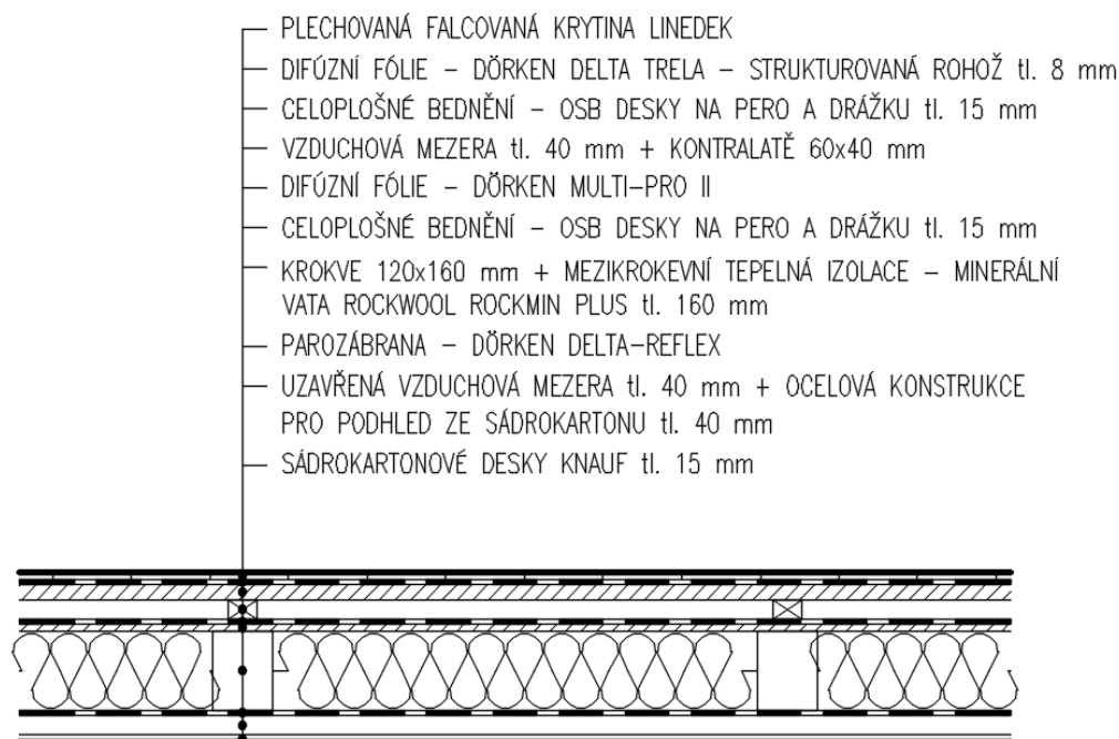
Obr. 57 – Skladba střešního pláště s plechovou falcovanou krytinou
