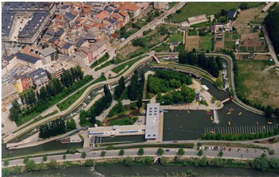
Obrázek 5: Areál olympijské dráhy ve španělském La seu. Konstrukce je specifická především díky kombinaci přečerpávacího systému a říčního toku (dostupné na https://www.canoeicf.com/canoe-slalom-world-cup/la-seu-durgell-2018/spectator-guide )
