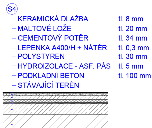
Obr. 20 Stávající skladba podlahy na terénu
