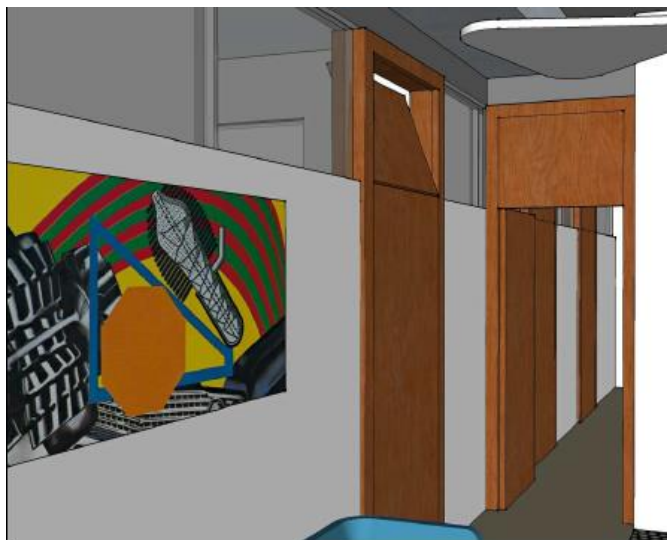
Obr. 63 Provětrávací automatický nadsvětílík dveří [18]
