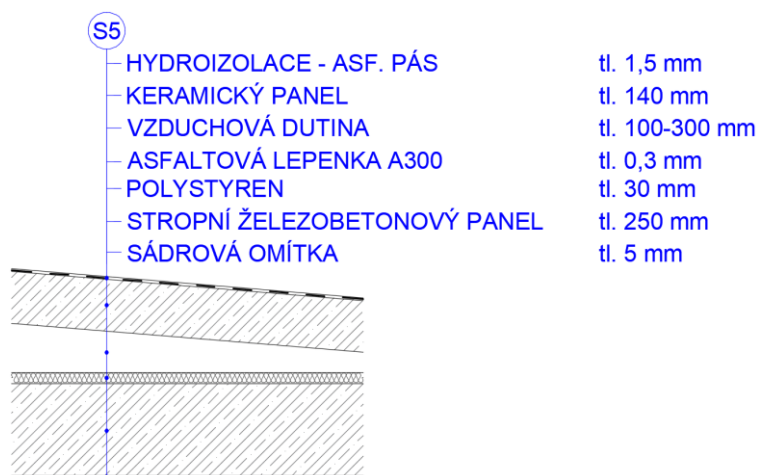
Obr. 21 Stávající skladba střechy
