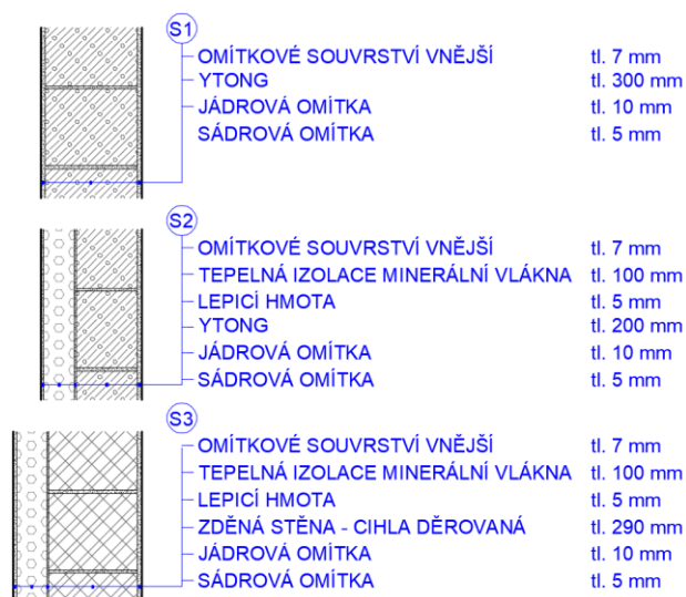
Obr. 19 Stávající skladby stěn
